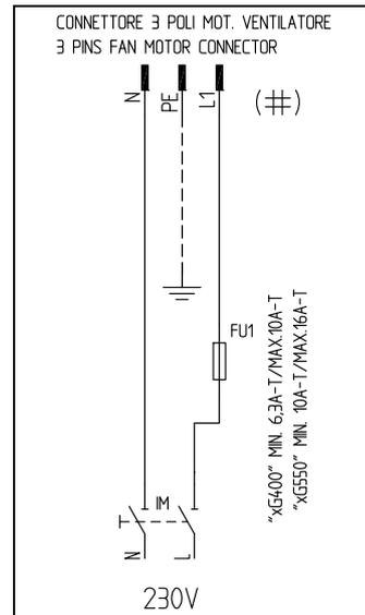
Fig. 24 - Conector 3-polos por el motor eléctrico
