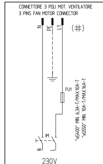
Fig. 26 - Conector 3-polos por motor eléctrico
