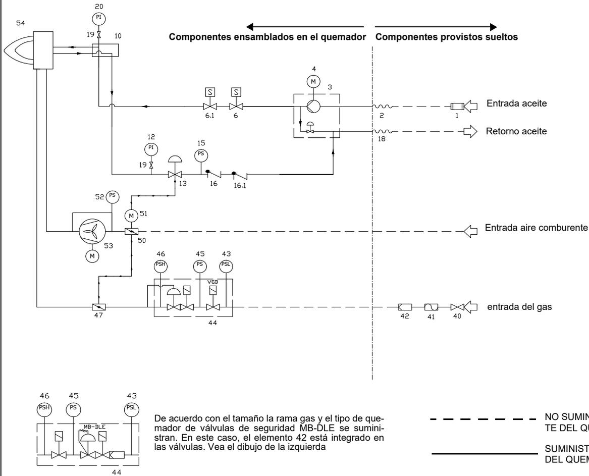
De acuerdo con el tamaño la rama gas y el tipo de quemador de válvulas de seguridad MB-DLE se suministran. En este caso, el elemento 42 está integrado en las válvulas. Vea el dibujo de la izquierda
