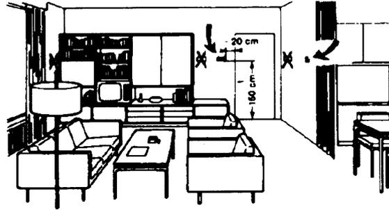
**Sondas externas (climáticas)Montaje**
