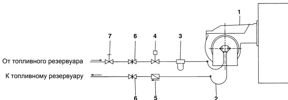
Рис. 15 - Двухтрубная система
