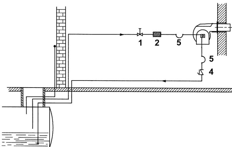
ПРИМЕЧАНИЕ В системах с гравитационной подачей или с кольцевым контуром, установить автоматическое отсечное устройство (см. № 4-Рис. 16).
