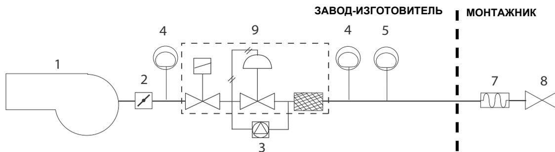
Газовая рампa с группой клапанов VGD со встроенным стабилизатором давления газа + блок контроля герметичности VPS504
