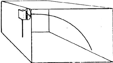
Согнуть вручную (никогда не применять инструменты!), как на рисунке датчик на 0,4 м
