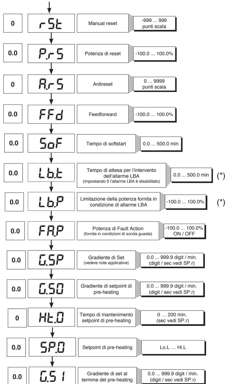
(\*) Se l'allarme LBA è attivo, si può annullare premendo i tasti  $\Delta$  +  $\nabla$  quando sul display è visualizzato il valore dell'uscita di regolazione (OutP), oppure commutando in Manuale.
