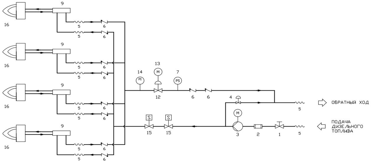
**насосно-топливная дизельная группа горелок серии HR.. VS (с мощностью ≥ 3 МВт)**
