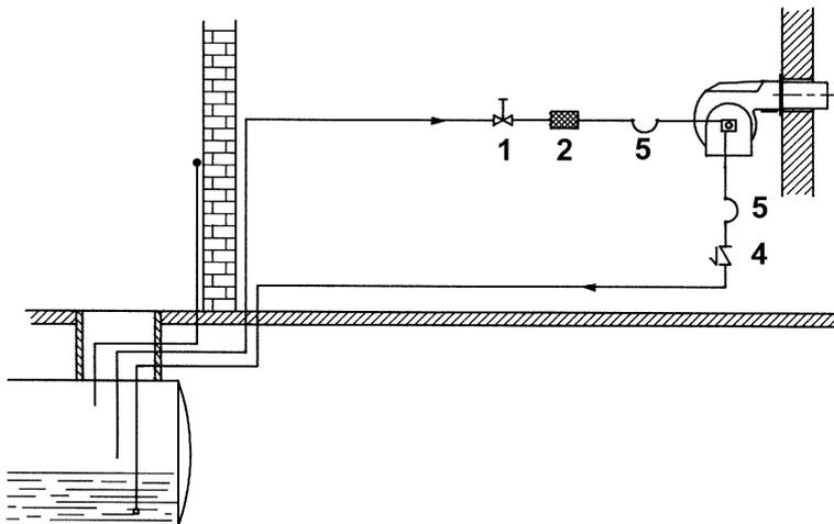
**ПРИМЕЧАНИЕ:** в системах с гравитационной подачей или с кольцевым контуром, установить автоматическое отсечное устройство (см. № 4 Рис. 10).
