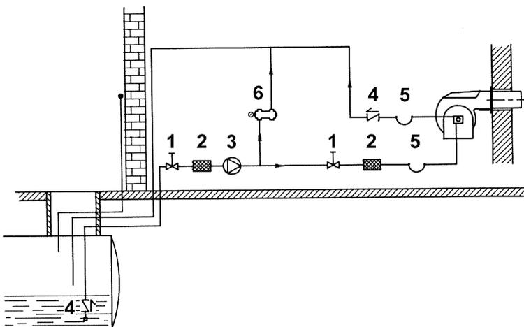
Рис. 15- - Контур подачи топлива всасыванием
