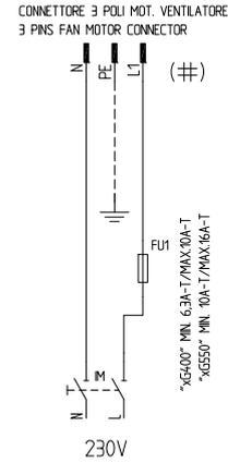
Fig. 16 - Connettore 3 poli per motore elettrico
