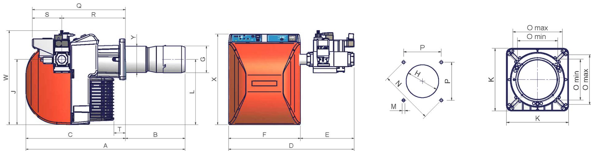
Foratura caldaia e flangia bruciatore
