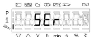
Il livello Service permetti di visualizzare informazioni sull’intensità di fiamma, posizione servocomandi, numero e codici di blocco:
