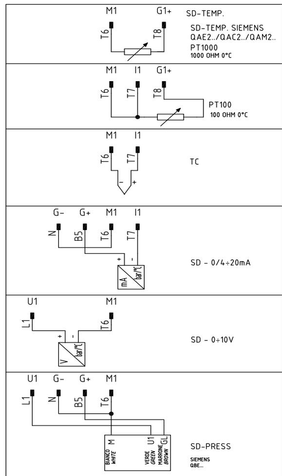
Fig. 34 - Collegamento sonde
