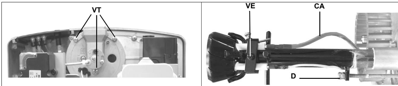
**Corretta posizione degli elettrodi** Al fine di garantire una buona accensione è necessario che siano rispettate le misure indicate in figura. Accertarsi di aver fissato la vite di bloccaggio **VE** del gruppo elettrodi prima di rimontare il bruciatore. **Bruciatori standard**
