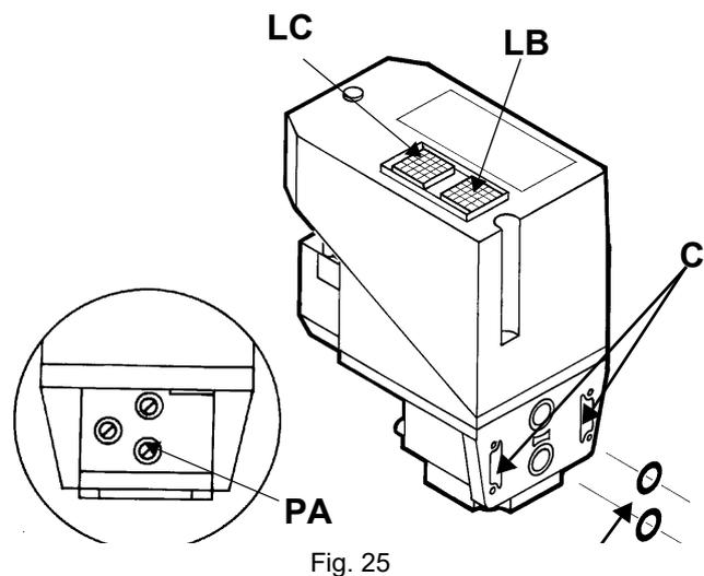
Per effettuare la verifica di funzionamento, inserire un manometro in corrispondenza della presa di pressione **PA** (Fig. 9). Se il ciclo di prova ha esito positivo, dopo alcuni secondi si accende la lampada di consenso **LC** (gialla). In caso contrario si accende il pulsante luminoso **LB** di blocco (rossa). Per ripartire è necessario sbloccare l'apparecchiatura premendo il pulsante **LB**.
