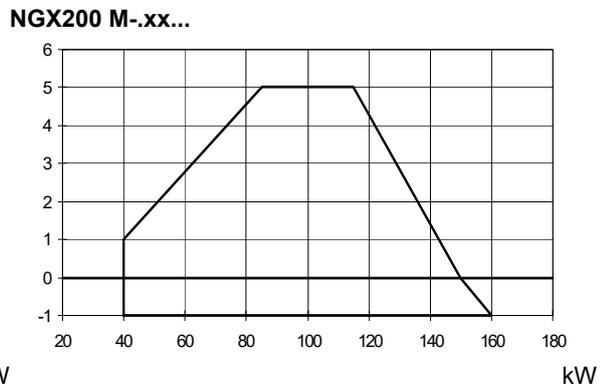
Per ottenere la potenza in kcal/h, moltiplicare il valore di potenza in kW per 860.
