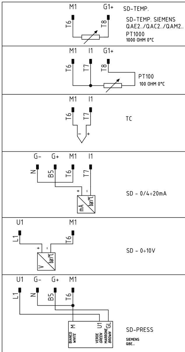
Fig. 10 - Connettore a 7 poli per collegamento sonde
