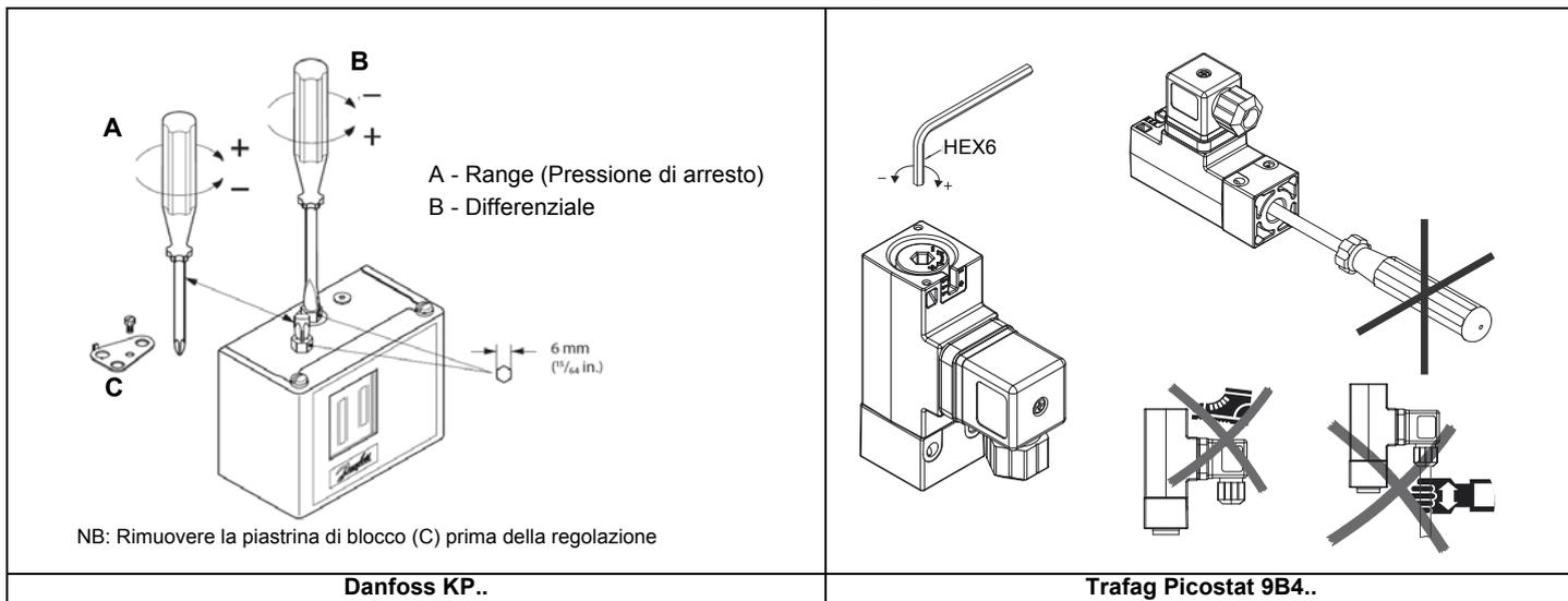
**Pressostato di massima olio - taratura**
