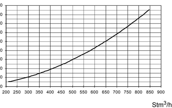
Curve pressione in testa di combustione - portata gas (GPL)
