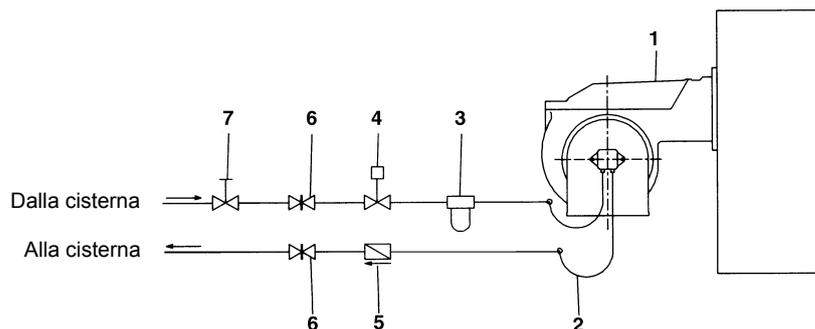
Fig. 12 - Sistema bitubo
