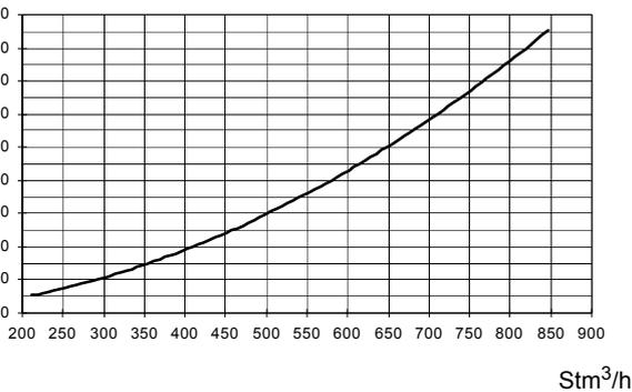
Curve pressione in testa di combustione - portata gas (GPL)
