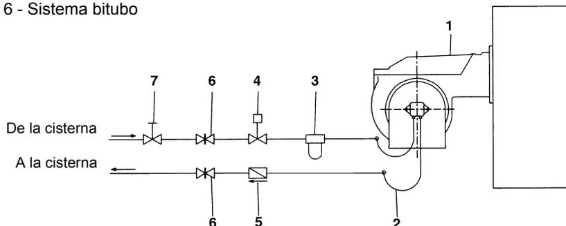
El suministro preve el filtro y los flexibles, toda la parte ante del filtro y la parte despues del latiguillo de retorno, tiene que ser predispuesta por el usuario. Por la conexion de los flexibles, consultar el relativo párrafo.
