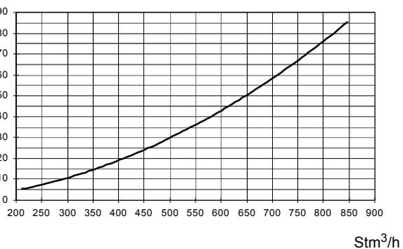
**Curvas de presión - caudal en cabezal de combustión (LPG)**
