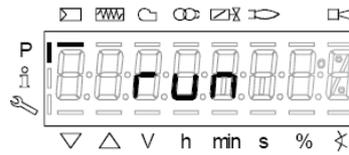
il bruciatore è pronto per partire. A questo punto si possono impostare i punti della curva, in base ai valori di combustione, premendo il tasto “enter”.
