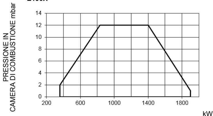
Per ottenere la potenza in kcal/h, moltiplicare il valore di potenza in kW per 860.
