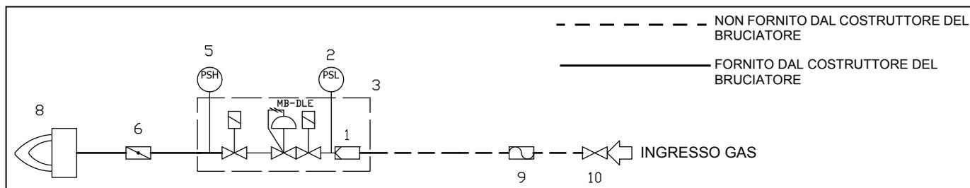
Rampa con gruppo valvole VGD con stabilizzatore di pressione gas incorporato
