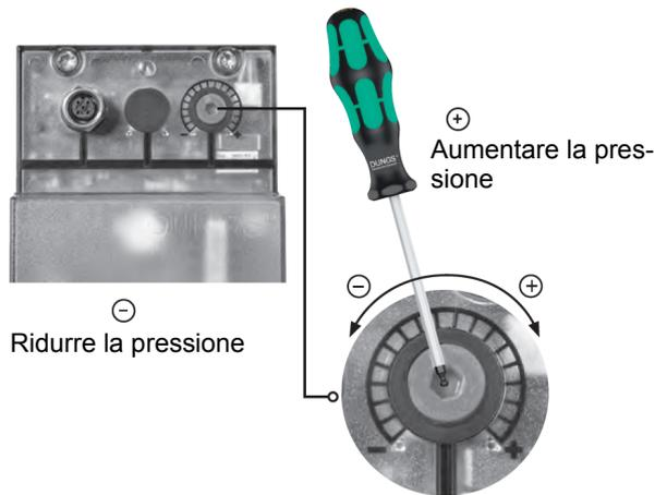
**! Non lineare! Diversi sensori installabili. Pressione di uscita a seconda del range di misurazione del sensore.**
