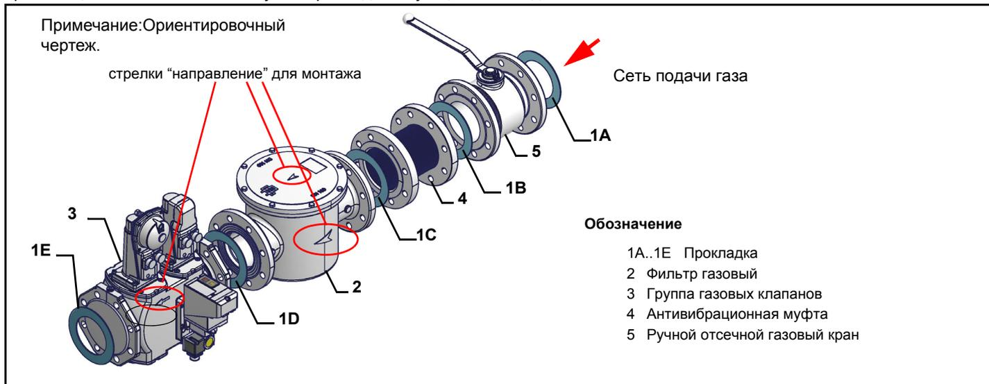
Монтаж корпуса клапана на газовой линии:
