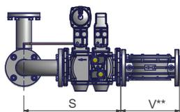
(\*\*) В зависимости от размера газовой рампы и типа горелки, могут поставляться клапаны типа VGD или MB-DLE. Отметка "V" касается газового фильтра и относится к горелкам, поставляемым с клапанами Siemens VGD. Клапаны MB-DLE имеют встроенные фильтры.
