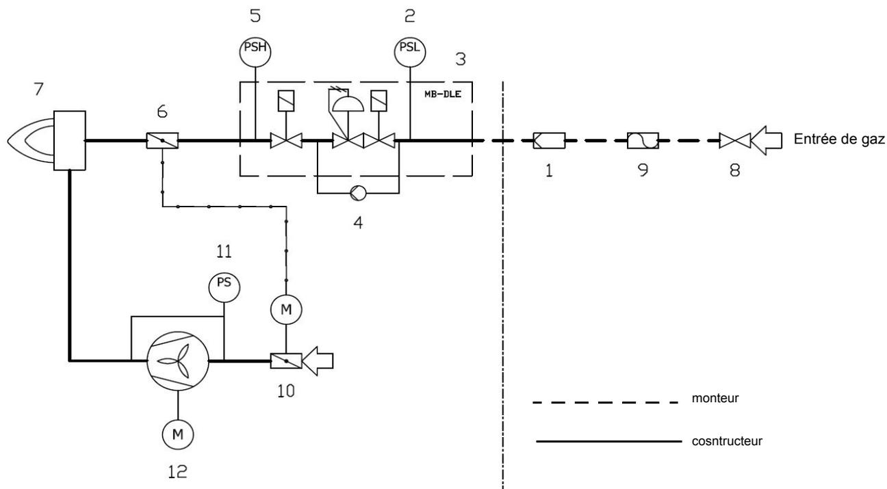
**\*Remarque** : Le pressostat peut être monté en amont ou en aval des vannes de gaz, mais en amont de la vanne papillon (voir schéma - élément 4).
