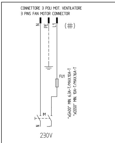
Fig. 20 - Branchement moteur électrique
