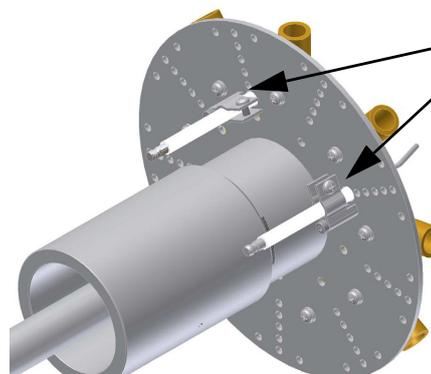
**Sustitución del electrodo de detección (quemadores de gas natural)**
