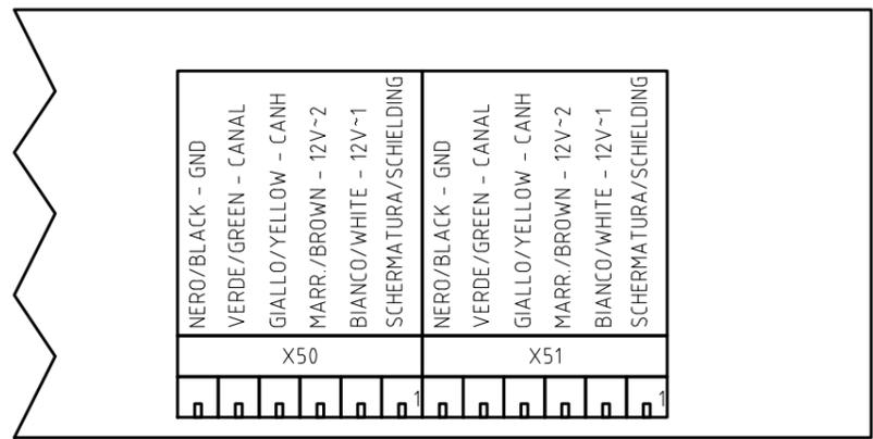
ESECUZIONE DELLA CONNESSIONE TRA LMV5x E SERVOCOMANDI < 20 METRI
