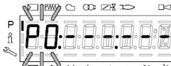
Premere “F” e “+” per aumentare l’angolo di apertura del servocomando combustibile “0F” fino al valore desiderato (per esempio 12° ÷ 15° -vedi sotto) per il punto di accensione oppure “F” e “-” per diminuire l’angolo:
