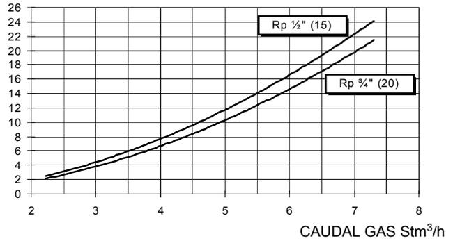
Los valores de los diagramas se refieren a **Gas Natural** con un poder calorífico de 8125 kcal/Stm<sup>3</sup> (15°C, 1013 mbar) y una densidad de 0,714 kg/Stm<sup>3</sup>. Cuando el poder calorífico y la densidad varían, los valores de presión deben ser corregidos en consecuencia.
