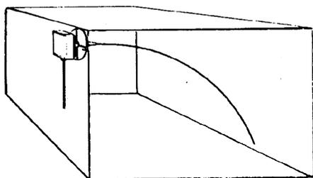
Согните вручную (запрещается использовать инструменты), как показано на рисунке, датчик 0,4 м.
