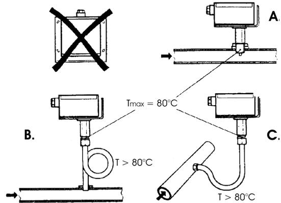
**Монтаж дифференциальных датчиков давления для воды**
