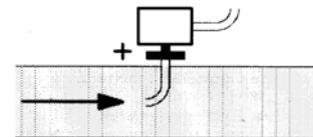
**Подключение датчика давления Siemens QBE 620 P... к клеммнику горелки**
