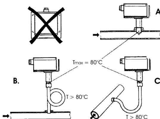
Согнуть вручную (никогда не применять инструменты!), как на рисунке датчик на 0,4 м.
