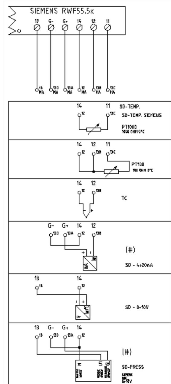
Correspondences bornes entre RWF55.5x y RWF40.0x0 Соответствия клемм модуляторов RWF55.5x и RWF40.0x0
