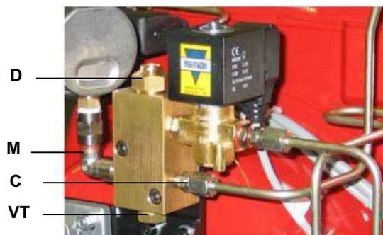
Рис. 12 - Ручной регулятор жидкого топлива
