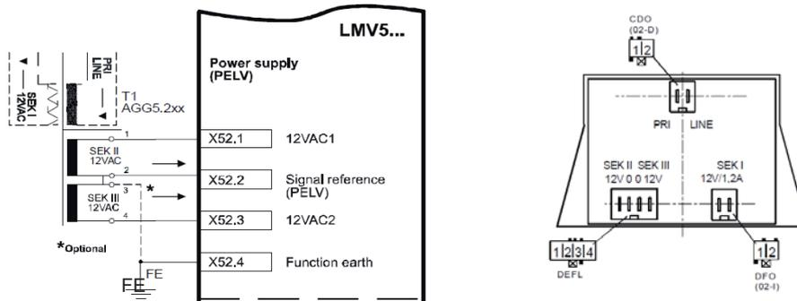
In alcuni casi, connettere il terminale X52.2 con FE, migliora la resistenza dell'LMV5 ai disturbi EMC. Effettuare la connessione e controllare: nel caso non ci fosse alcun miglioramento, rimuovere la connessione.
