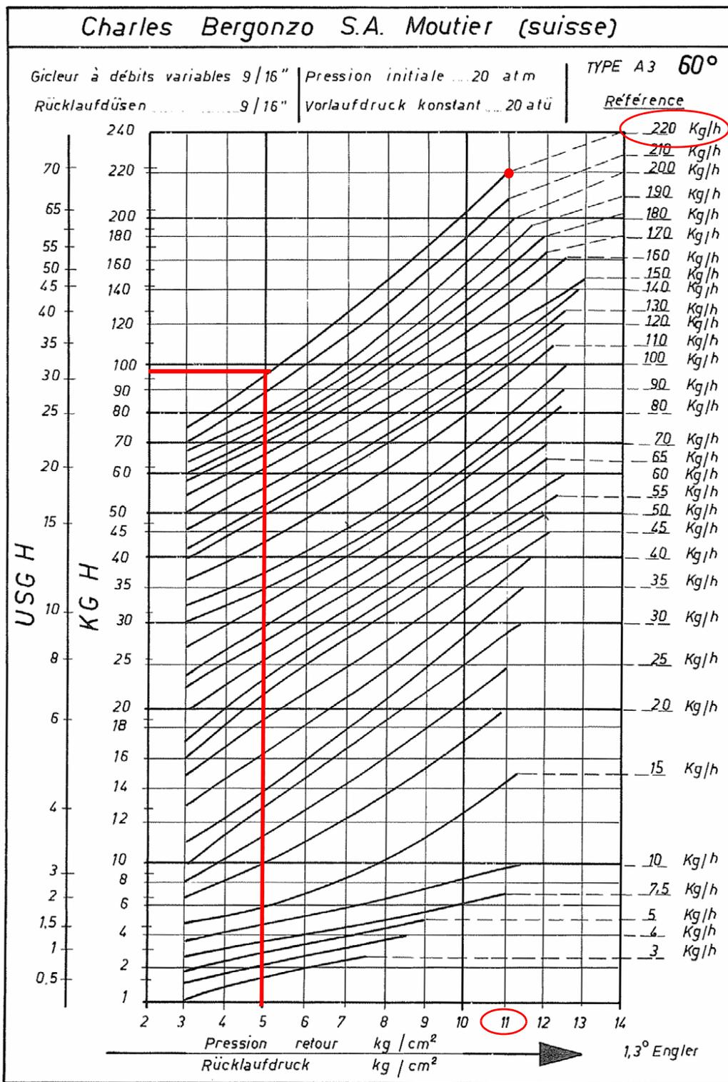
**Esempio:** se si ha in dotazione un ugello Bergonzo, con portata di 220 kg/h, si regola la pressione massima sul ritorno a 11 bar, alimentando a 20 bar in mandata: si ottiene una portata di 220 kg/h. Se, invece la pressione di ritorno che si vuole è di 5 bar, si deve agire sulla vite di regolazione del regolatore di pressione. La portata che si otterrà sarà circa 95 kg/h (vedi esempio riportato sul diagramma).
