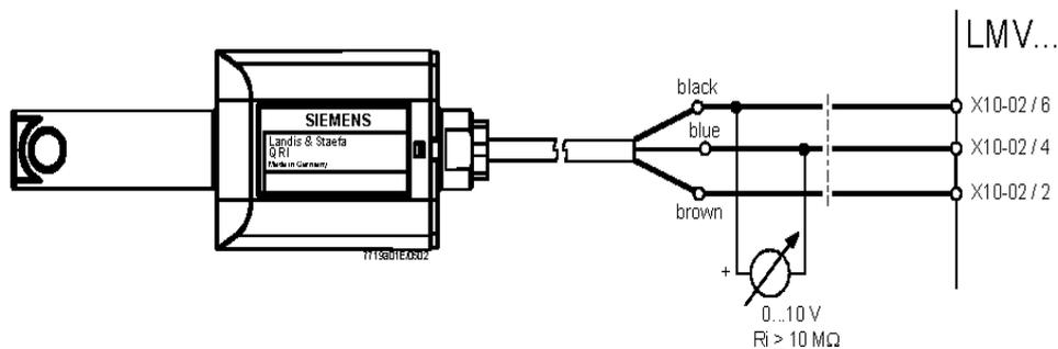
Fig. 19 - Rilevazione con fotocellula QRI..
