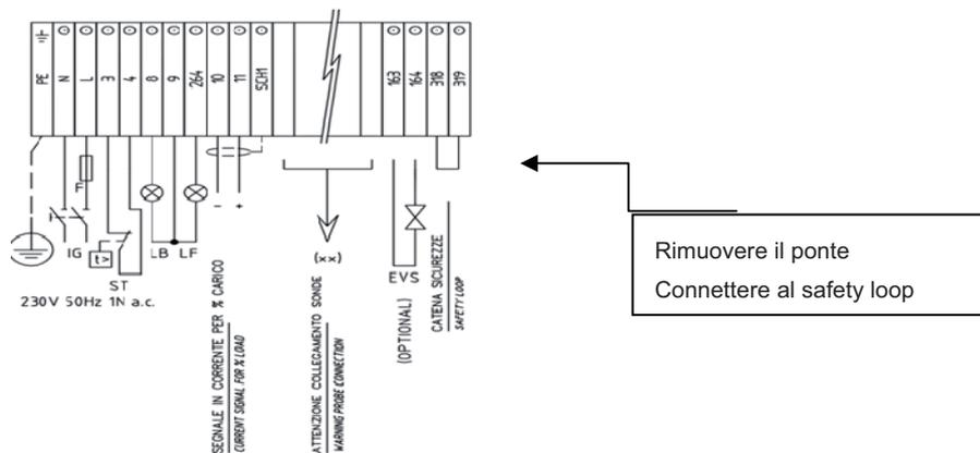
**NOTA:** Quando safety loop apre, il bruciatore si spegne immediatamente, saltando la fase di bassa fiamma. E' importante distinguere la "serie termostatica" da "safety loop"
