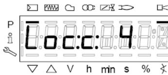
significa che il bruciatore è in **blocco (Lockout)** con codice errore (Error code): nell'esempio "Codice errore: 4". Verrà visualizzato alternato anche il messaggio
