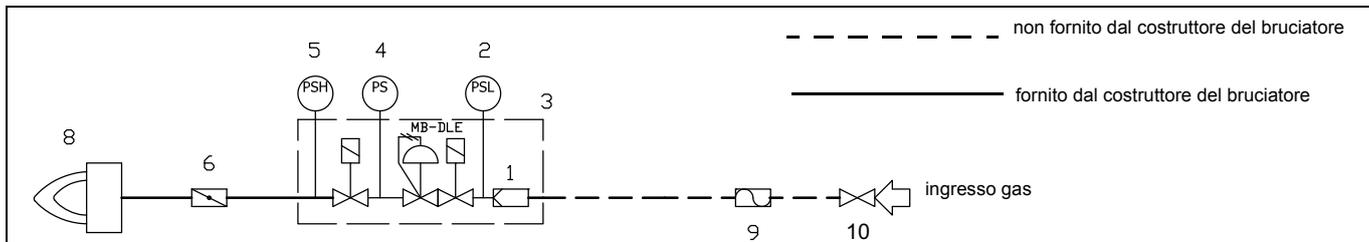
Rampa con gruppo valvole VGD e MBE con stabilizzatore di pressione gas incorporato + pressostato gas controllo perdite (PGCP)
