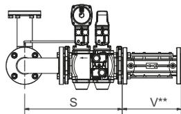
(\*\*) A seconda della dimensione della rampa gas e del tipo bruciatore, possono essere fornite valvole VGD o MB-DLE. La quota "V", riguarda il filtro gas e fa riferimento a bruciatori forniti con valvole Siemens VGD. Le valvole MB-DLE integrano il filtro al loro interno.
