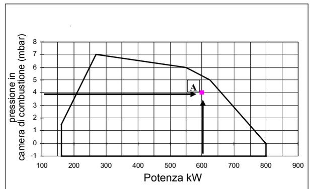
Tracciare, sul diagramma "Campo di lavoro" del bruciatore, una retta verticale in corrispondenza della potenza al focolare e una retta orizzontale in corrispondenza del valore di pressione di interesse. Il bruciatore è idoneo solo se il punto di intersezione "A" delle due rette, ricade all'interno del campo di lavoro.
