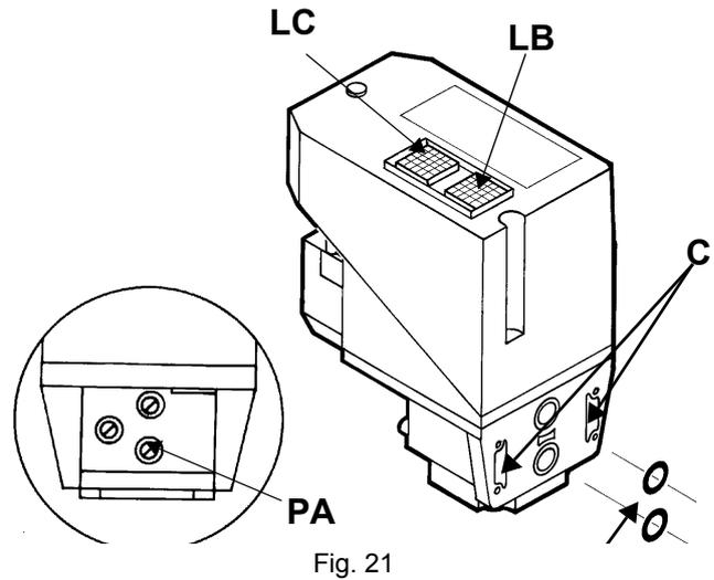
Per effettuare la verifica di funzionamento, inserire un manometro in corrispondenza della presa di pressione **PA** (Fig. 21). Se il ciclo di prova ha esito positivo, dopo alcuni secondi si accende la lampada di consenso **LC** (gialla). In caso contrario si accende il pulsante luminoso **LB** di blocco (rossa). Per ripartire è necessario sbloccare l'apparecchiatura premendo il pulsante **LB**.
