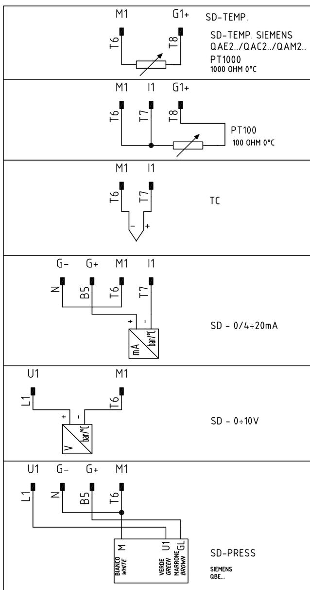
Fig. 9 - Connettore a 7 poli per collegamento sonde
