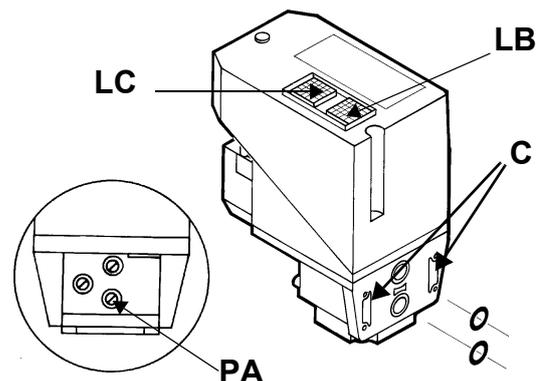
Per effettuare la verifica di funzionamento, inserire un manometro in corrispondenza della presa di pressione **PA** (Fig. 21). Se il ciclo di prova ha esito positivo, dopo alcuni secondi si accende la lampada di consenso **LC** (gialla). In caso contrario si accende il pulsante luminoso **LB** di blocco (rossa). Per ripartire è necessario sbloccare l'apparecchiatura premendo il pulsante **LB**.
