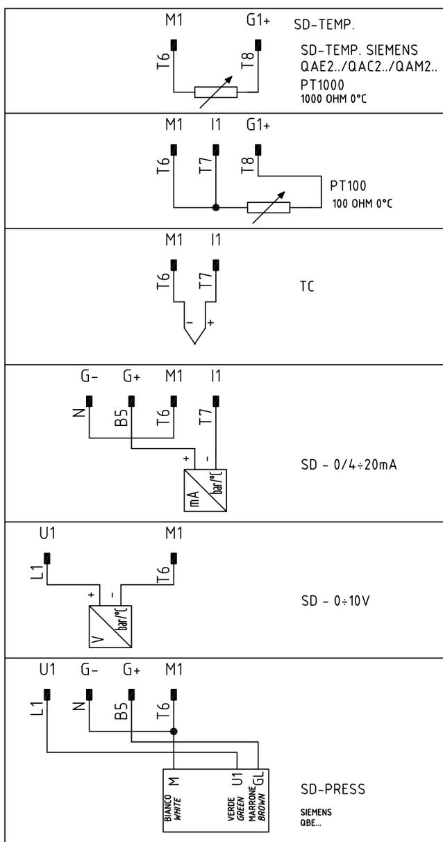
Рис. 9 - 7-х полюсный соединительный разъем для подсоединения датчиков
