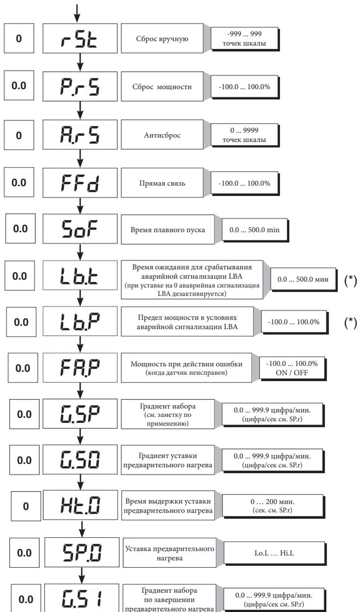
(\*) Если аварийная сигнализация LBA активирована, можно аннулировать ее нажатием на клавиши Δ + ∇, когда на дисплее отображено величина значения выхода регулирования (OutP), или перейдя в ручной режим.
