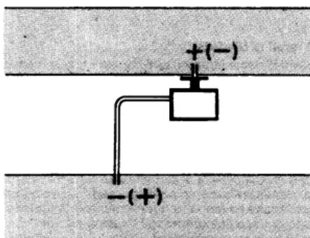
С – Измерение разницы давления между двумя каналами
