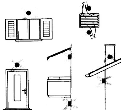
Не устанавливать рядом с окнами, вентиляционными решетками, снаружи котельной, на дымовых трубах или под защитой балконов и навесов.
