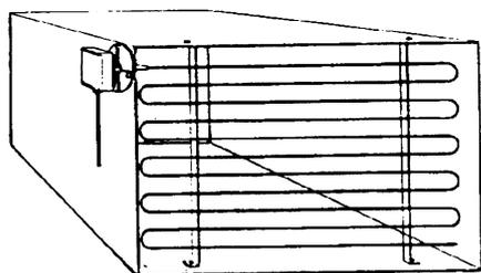
Уложите по всему сечению канала, мин. расстояние от стенок - 50 мм, радиус закругления - 10 мм для датчиков 2 или 6 м
