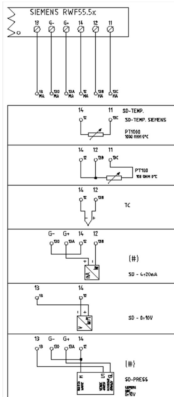
Correspondences bornes entre RWF55.5x y RWF40.0x0 Соответствия клемм модуляторов RWF55.5x и RWF40.0x0
