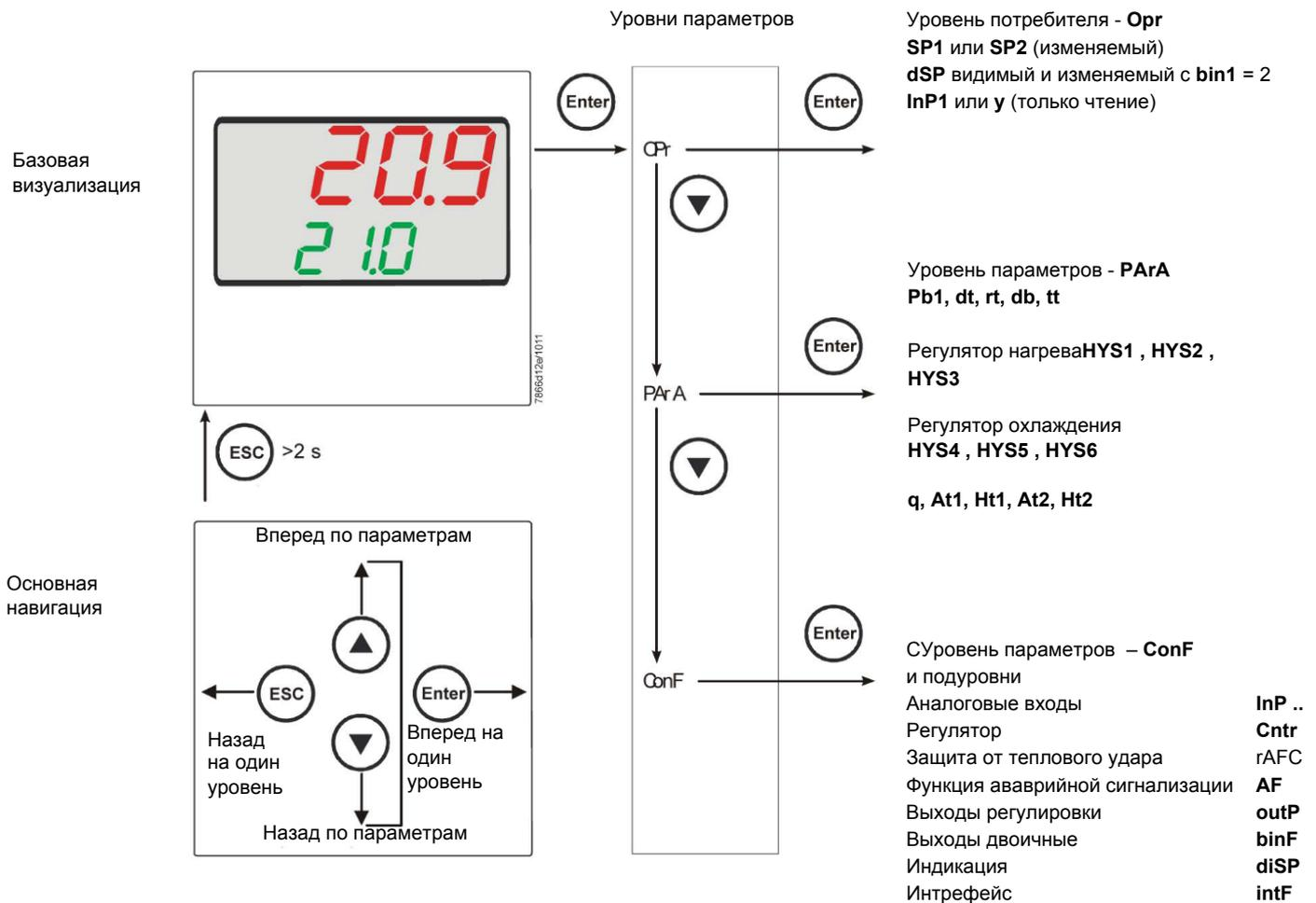
На заводе – изготовителе в прибор уже вводятся некоторые уставки, которые могут быть пригодны в 90% случаев; для введения или изменения параметров необходимо действовать следующим образом:
