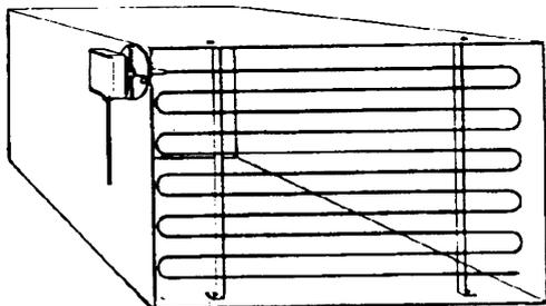
Расположить по всему сечению канала, минимальное расстояние от стенок 50 мм, радиус изгиба 10 мм для датчиков на 2 или 6 м
