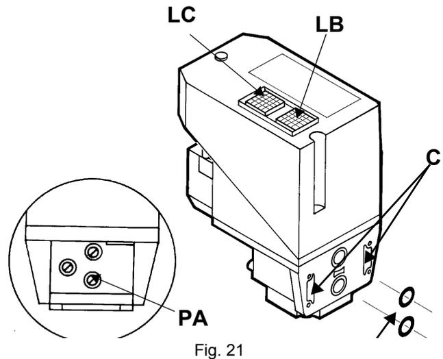
Si se desea realizar un control, introducir un manómetro en la toma de presión **PA** en Fig. 24. Si el ciclo de prueba resulta positivo, después de algunos segundos se enciende la lámpara de consenso **LC** (amarilla). En caso contrario se enciende la lámpara **LB** de bloqueo (roja). Para reiniciar es necesario desbloquear el equipo presionando el pulsador luminoso **LB**.
