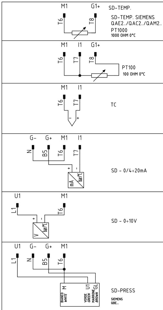
Fig. 9 - Conector 7-polos por conexión de las sondas
