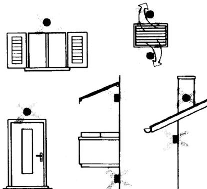
Evitar montaje en proximidad de ventanas, rejillas de aireación, al externo del local caldera, sobre chimeneas o protegida por balcones o cobertizos. La sonda no debe ser pintada (error de medida)
