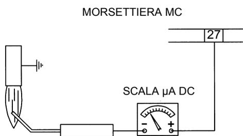
Fig. 13: Rilevazione con elettrodo
