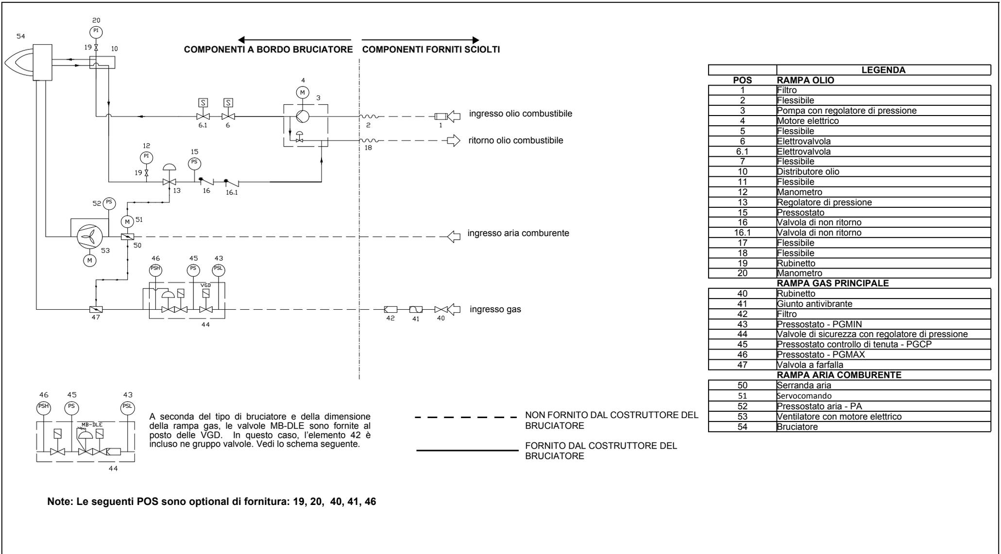
Fig. 3 - Schema idraulico
