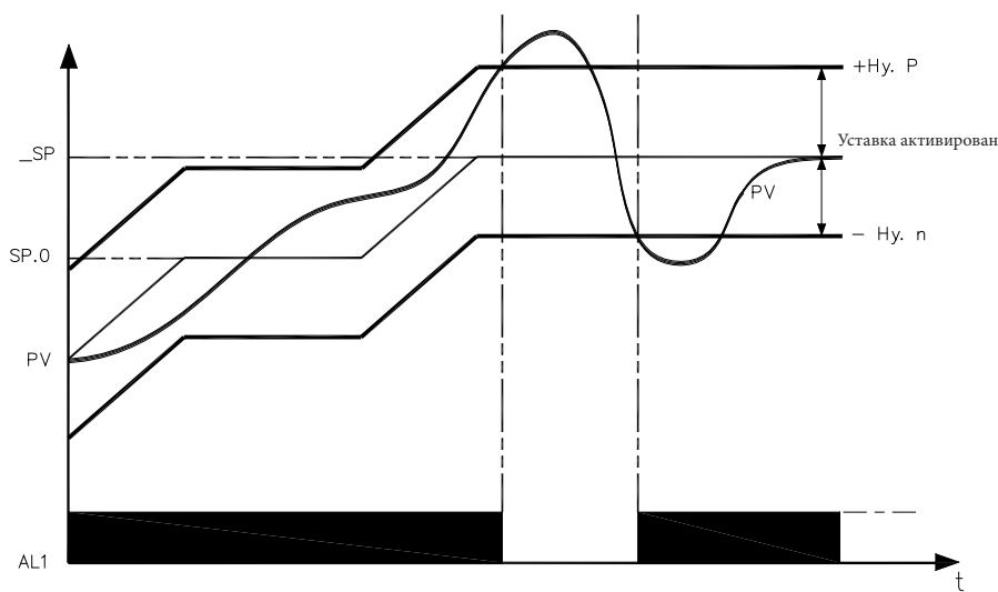
Сигнал о готовности горелки получается при конфигурации Тревоги 1 в качестве относительной обратной с положительным гистерезисом  $Hy.P$  и отрицательным гистерезисом  $Hy.n$ .
