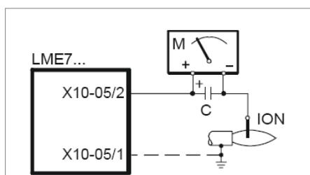
Рис. 21 - Контроль пламени с помощью электрода
