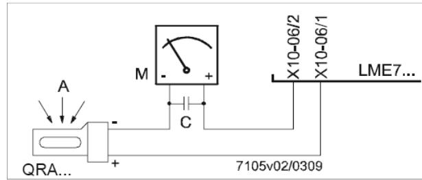
Рис. 23 - Контроль пламени с помощью фотоэлемента QRA.
