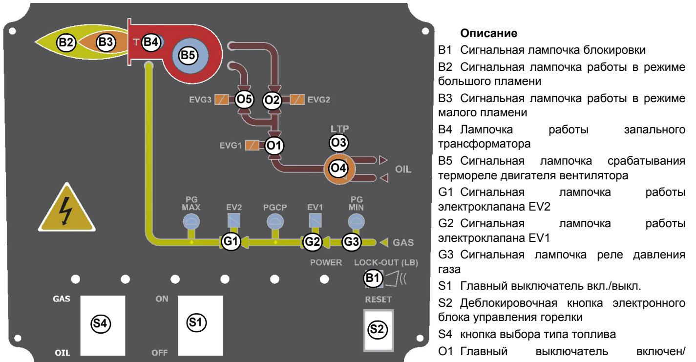
Рис. 8: передняя панель электроощита горелки
