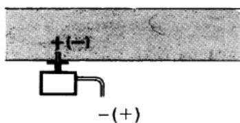
D – Измерение разницы давления между двумя средами или между внутренней частью канала и наружной средой
