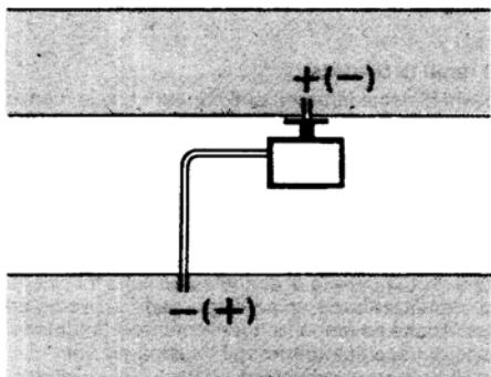
C - Измерение разницы давления между двумя каналами
