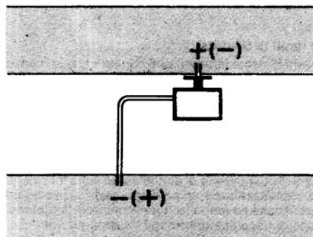
C. измерение разницы давления между двумя каналами
