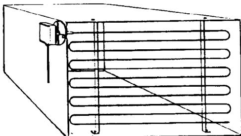
Расположить по всему сечению канала, минимальное расстояние от стенок 50 мм, радиус изгиба 10 мм для датчиков на 2 или 6 м
