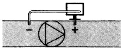
B – Проверка вентилятора (вход/выход)
