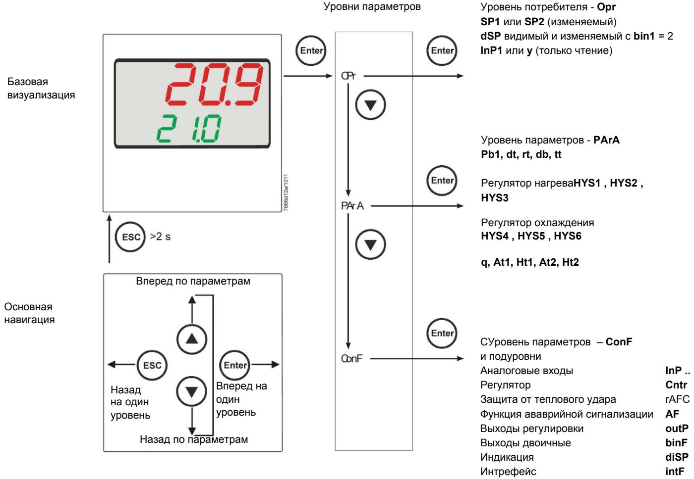
На заводе – изготовителе в прибор уже вводятся некоторые уставки, которые могут быть пригодны в 90% случаев; для введения или изменения параметров необходимо действовать следующим образом:
