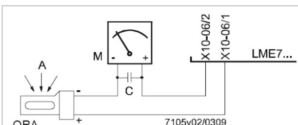
Рис. 22 - Контроль пламени с помощью фотоэлемента QRA.
