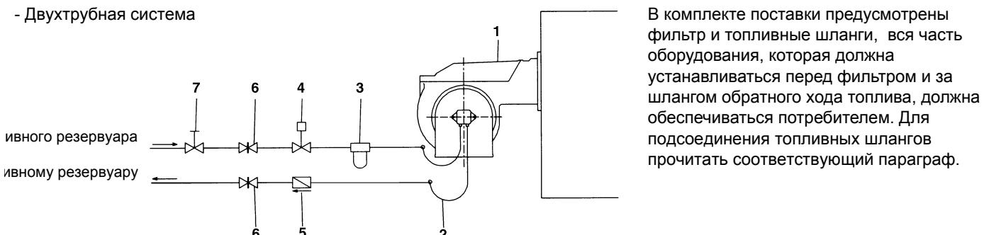
В комплекте поставки предусмотрены фильтр и топливные шланги, вся часть оборудования, которая должна устанавливаться перед фильтром и за шлангом обратного хода топлива, должна обеспечиваться потребителем. Для подсоединения топливных шлангов прочитать соответствующий параграф.
