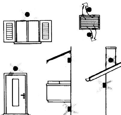
Избегать монтажа вблизи окон, воздушных решеток, снаружи котельной, на дымоходах, а также он не должен быть защищен балконом или навесом.
