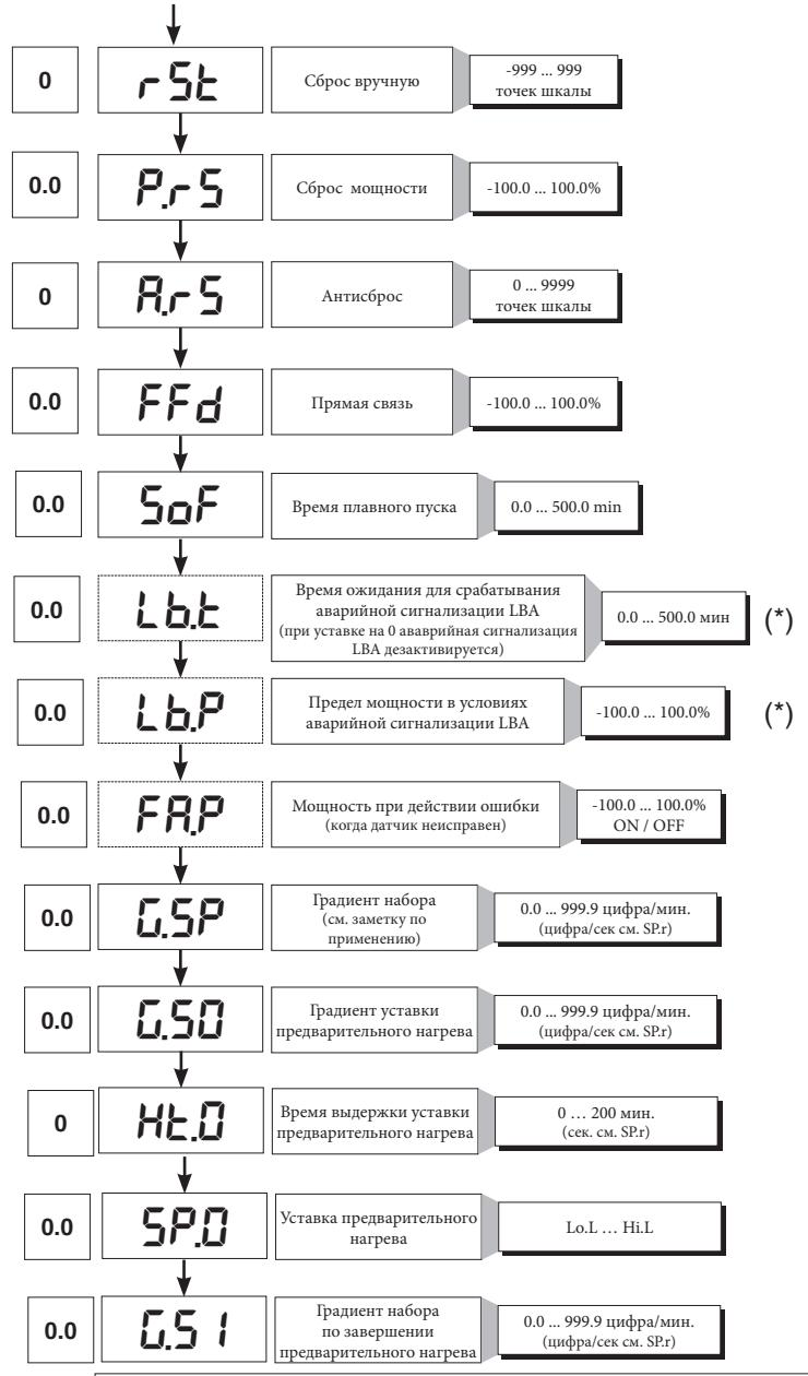
(\*) Если аварийная сигнализация LBA активирована, можно аннулировать ее нажатием на клавиши  $\Delta$  +  $\nabla$ , когда на дисплее отображено величина значения выхода регулирования (OutP), или перейдя в ручной режим.
