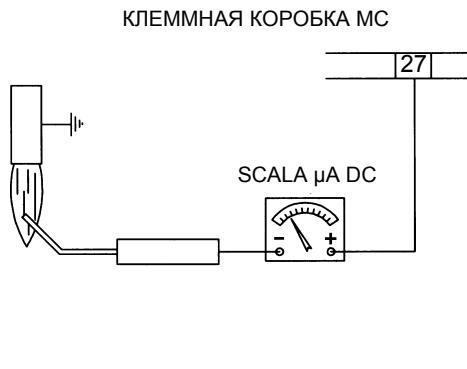
Рис. 19 - Контроль пламени с помощью электрода
