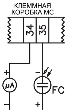
Рис. 20 - Контроль пламени с помощью фотоэлемента QRA.
