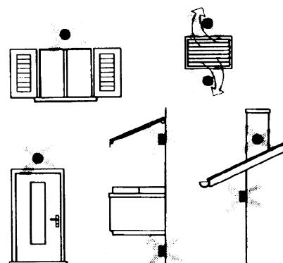
Не устанавливать рядом с окнами, вентиляционными решетками, снаружи котельной, на дымовых трубах или под защитой балконов и навесов.
