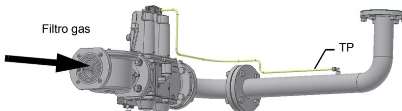
**Siemens VGD versione con SKP2 (stabilizzatore di pressione incorporato)**
