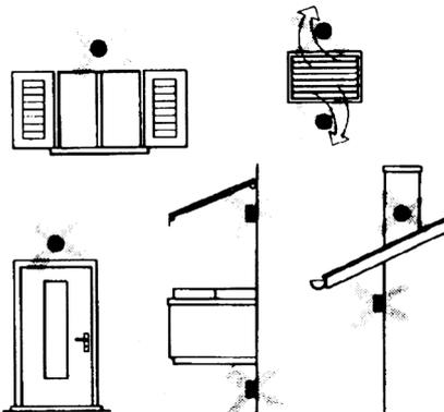
Éviter le montage près de fenêtres, de grilles de ventilation, à l'extérieur de la chaufferie, sur les cheminées ou protégé par des balcons, des auvents.
