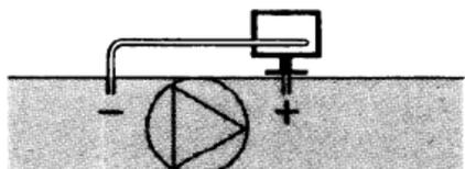
B - Contrôle du ventilateur (en amont/en aval)
