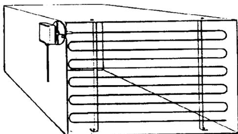
Poser sur toute la section du conduit, à une distance minimale de 50 mm des murs, rayon de courbure de 10 mm pour les sondes de 2 ou 6 m.
