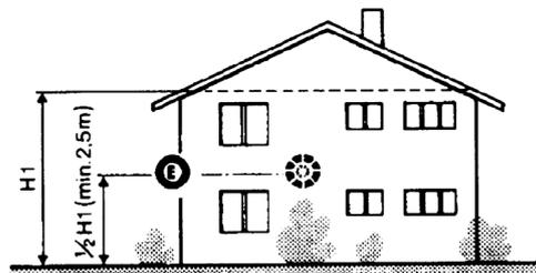
**Règle générale :** sur le mur extérieur du bâtiment correspondant aux pièces d'habitation, jamais sur la façade exposée au sud ou à un endroit exposé à la lumière du soleil du matin. En cas de doute, les placer sur la façade nord ou nord-ouest.
