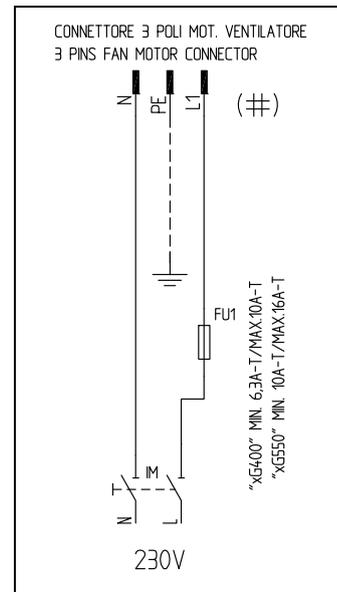
Fig. 21 Conector 3-polos por motor eléctrico NG/LG/NGX400
