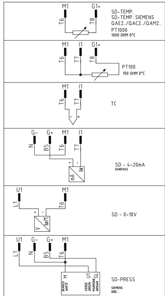
Fig. 24 - Conector 4-polos por conexión de las sondas
