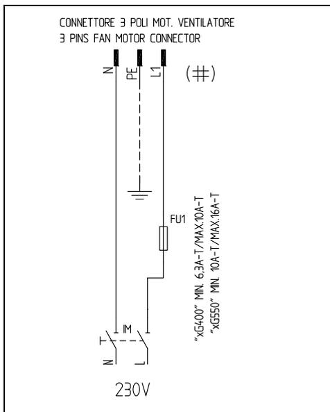
Fig. 23 - Conector 3-polos por motor eléctrico
