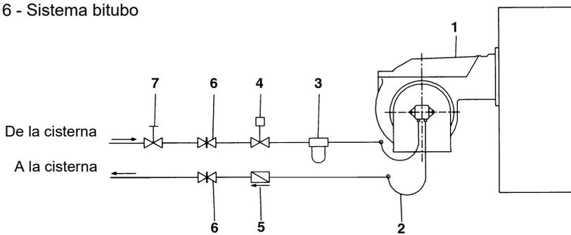
El suministro provee el filtro y los flexibles, toda la parte ante del filtro y la parte despues del latiguillo de retorno, tiene que ser predispuesta por el usuario. Por la conexion de los flexibles, consultar el relativo párrafo.
