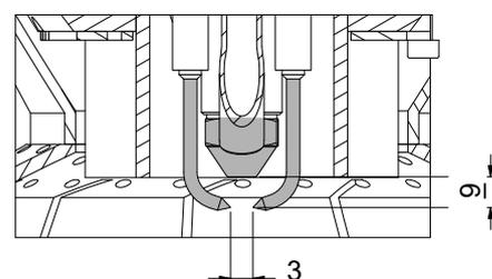
**Limpieza/sustitución de los electrodos**
