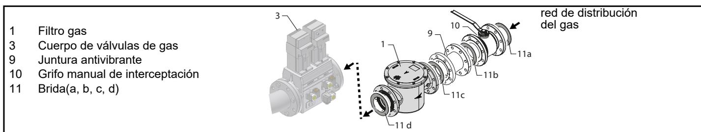
Montaje del cuerpo de válvula en la línea de gas: **para montar los grupos de válvulas de gas dobles, se necesitan 2 bridas con rosca o bridas según el diámetro;**
