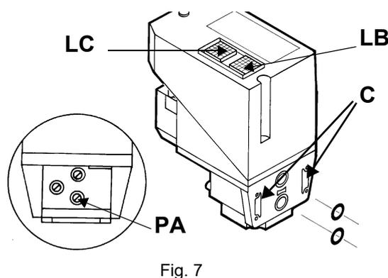
Si se desea realizar un control, introducir un manómetro en la toma de presión **PA** en Fig. 7. Si el ciclo de prueba resulta positivo, después de algunos segundos se enciende la lámpara de consenso **LC** (amarilla). En caso contrario se enciende la lámpara **LB** de bloqueo (roja). Para reiniciar es necesario desbloquear el equipo presionando el pulsador luminoso **LB**.
