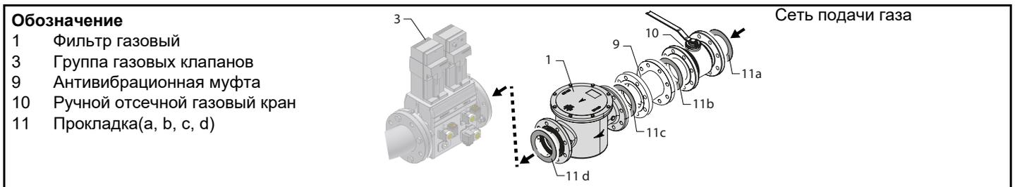
Монтаж корпуса клапана на газовой линии: для монтажа групп сдвоенных газовых клапанов требуются 2 резьбовых или фланцевых соединения, в зависимости от диаметра
