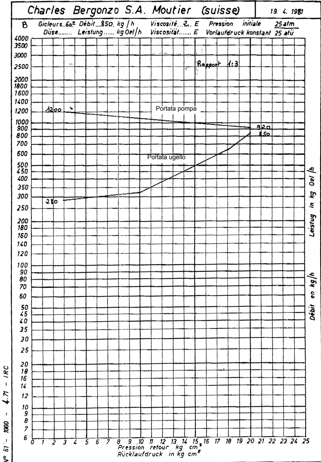
Fig. 22 - Ugello Bergonzo - Esempio con ugello da 850 kg/h
