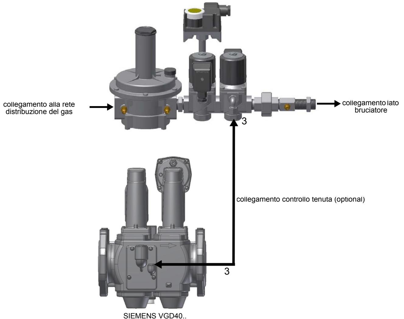
Fig. 6 - attacco (3) tubetto da rampa pilota al gruppo valvole della rampa principale (nello schema non è previsto ma si può eseguire)
