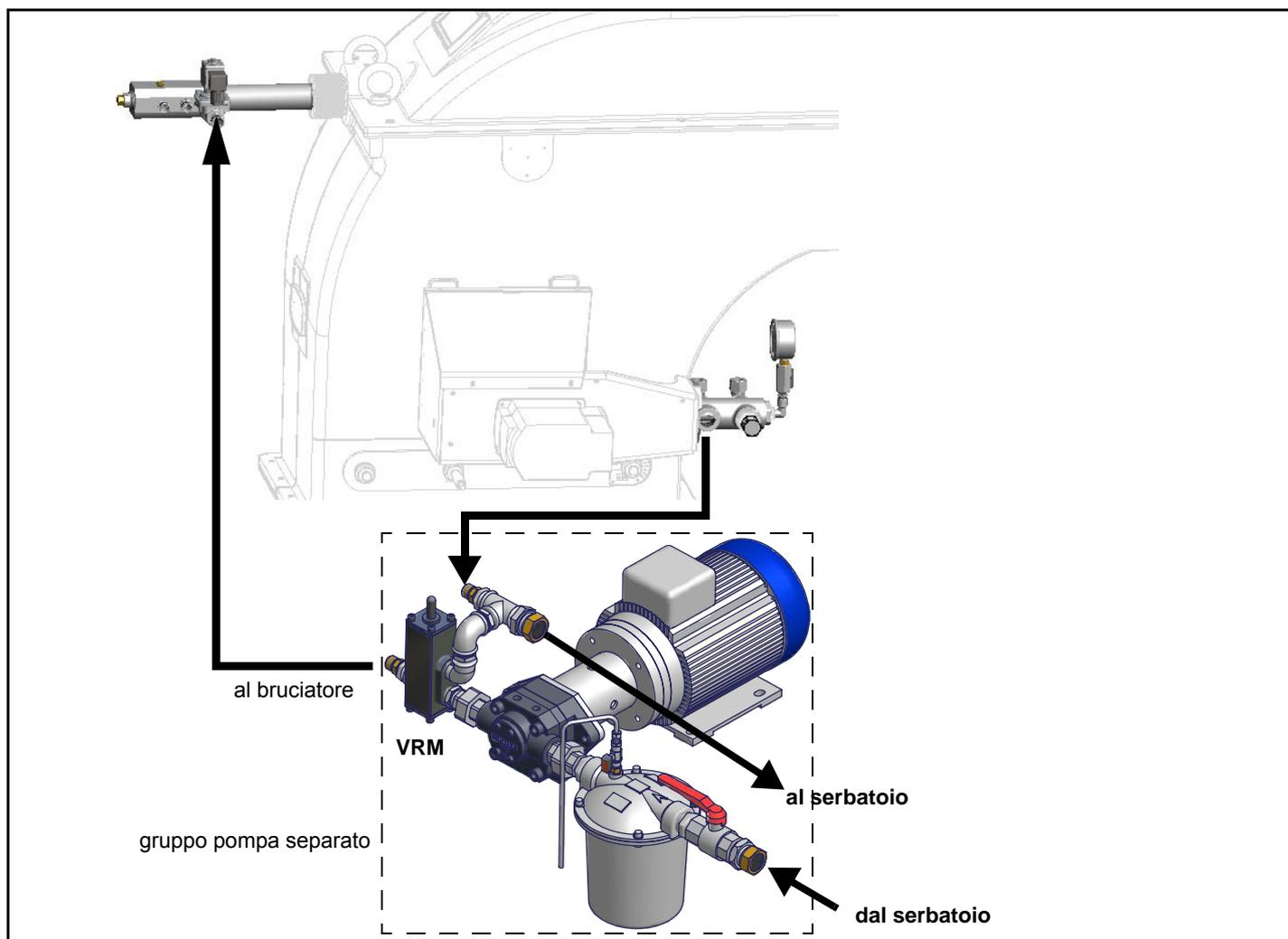
**ATTENZIONE:** i tappi di plastica non sono a tenuta ma servono solamente per il trasporto. I flessibili, tra pompa e bruciatore, sono quelli indicati in etichetta come "Flessibile alta pressione olio". Il flessibile indicato come "Flessibile bassa pressione" in etichetta, va collegato a monte filtro.
