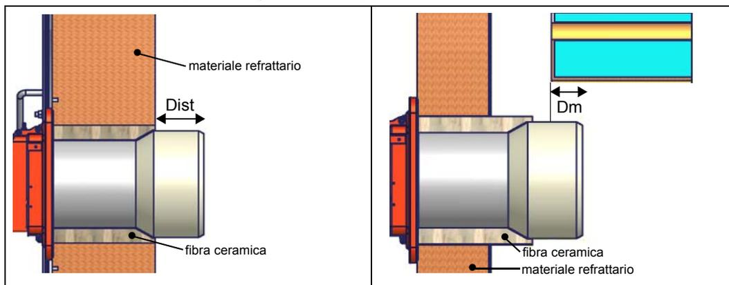
**ATTENZIONE! Sigillare con cura lo spazio libero tra boccaglio e tampone in refrattario della caldaia per mezzo di corda in fibra ceramica o altri mezzi idonei**
