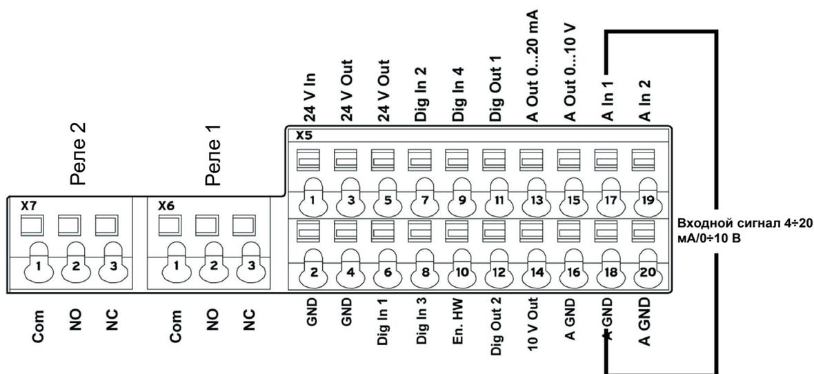
Вход AIn1 может быть сконфигурирован как вход под напряжением или под током, для LMV5-Etamatic — как вход под током 4-20 мА, для LMV2x/3x — как вход напряжения 0-10 В.
