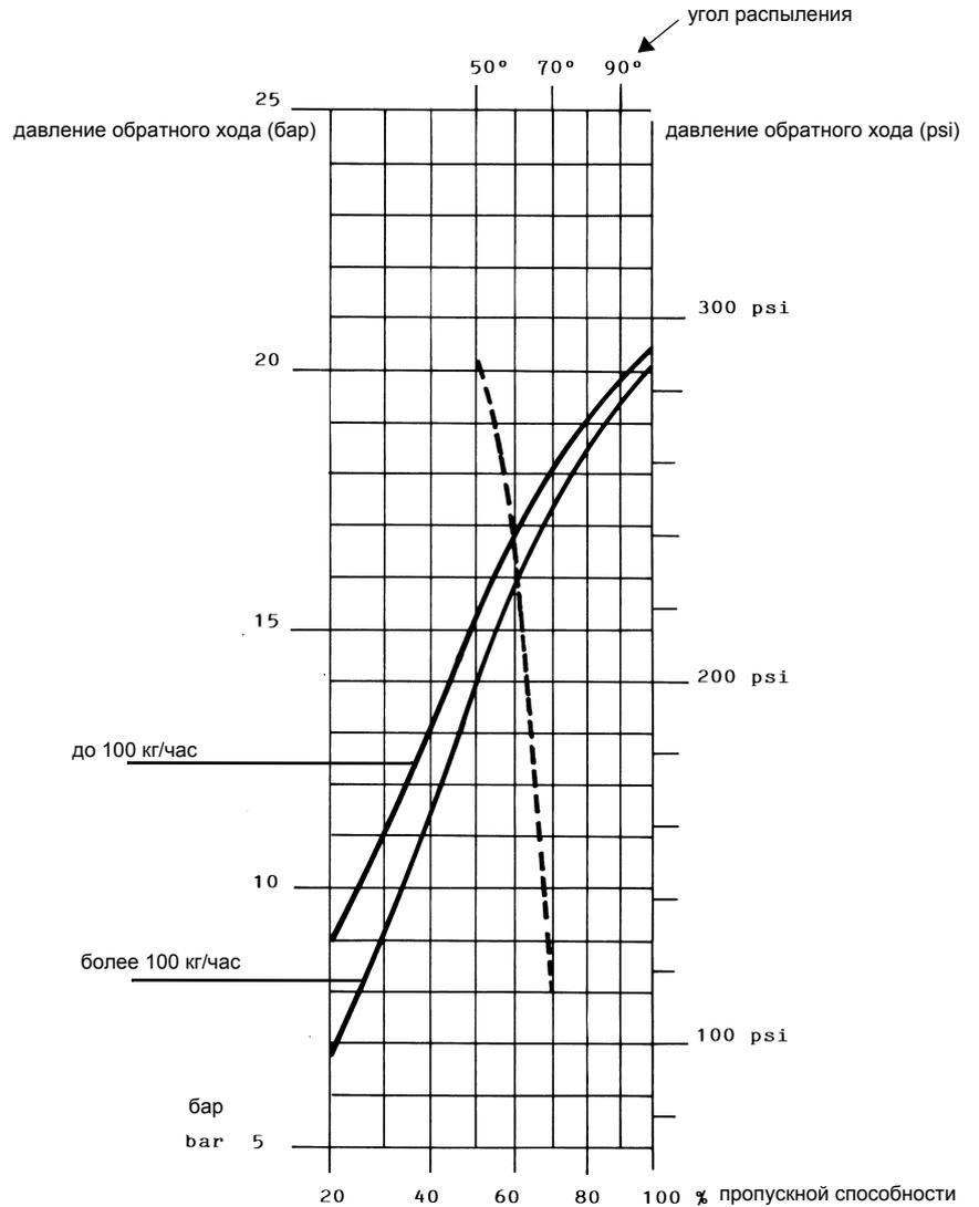
**ДАВЛЕНИЕ ТОПЛИВА НА ФОРСУНКЕ = 25 бар**
