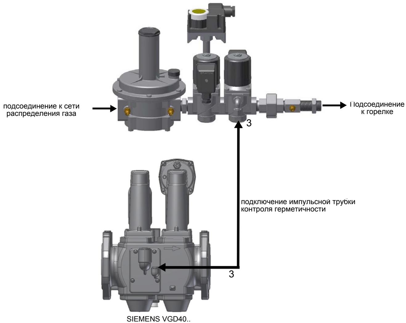
Рис. 6-подсоединение (3) трубки от рампы запальной горелки к клапанной группе основной газовой рампы
