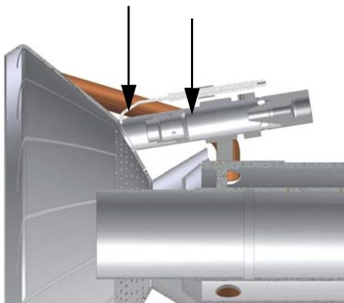
Рис. 24 - Часть головы сгорания с запальной горелкой (Р) и запальным электродом (Е)
