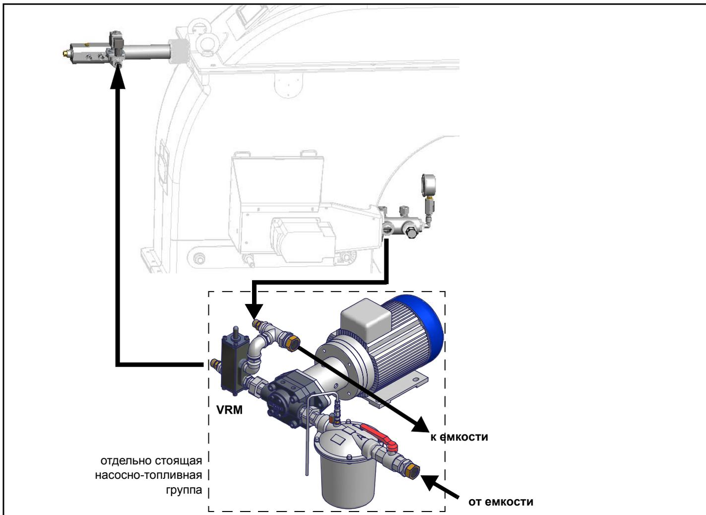
**ВНИМАНИЕ:** пластмассовые заглушки не герметичны и служат только в целях транспортировки. Шланги, подключаемые между насосом и горелкой, это шланги, обозначенные на этикетке, как "Шланги для жидкого топлива высокого давления". Шланг, обозначенный на этикетке, как " Шланг для жидкого топлива низкого давления", подключается перед фильтром.
