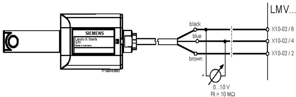
Рис. 26 - Детектирование с фотоэлементом QRI..
