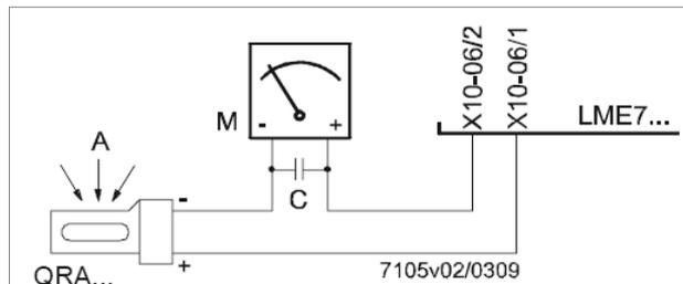
Fig. 34: Rilevazione con fotocellula QRA..
