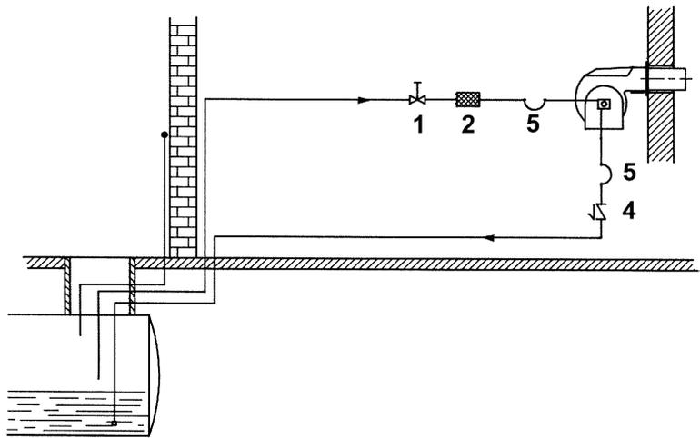
**NOTA:** negli impianti a gravità e ad anello, inserire un dispositivo di intercettazione automatica (vedere n. 4 - "" on page 24).
