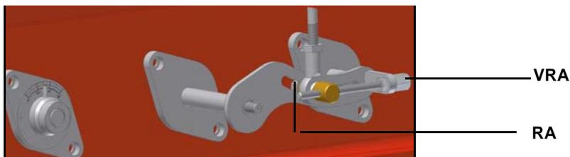
**Attenzione!** Ad operazioni ultimate, assicurarsi di aver fissato il dado di bloccaggio **RA**. Non cambiare la posizione dei tiranti della serranda dell'aria.
