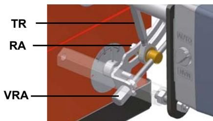
10 I bruciatori vengono regolati in fabbrica con la testa in posizione "MAX.", corrispondente alla massima potenza. Per il funzionamento a potenza ridotta, girare la vite **VRT** in senso orario e arretrare progressivamente la testa di combustione, verso la posizione "MIN.".
