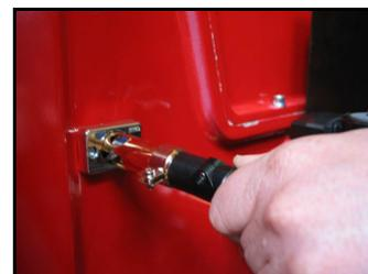
**Controllo della corrente di rilevazione**
