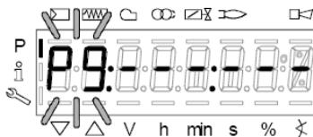
продолжать программирование вышеописанным способом, для ввода значений открытия сервоприводов воздуха (**A**) и топлива (**F**) и возможного инвертера (**F+A**) для LMV37
