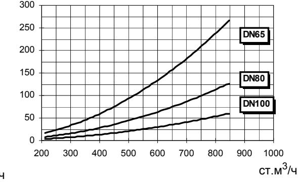
**Внимание:** на абсциссе указывается значение расхода газа, на ординате - соответствующее значение давления в сети без учета давления в камере сгорания. Чтобы определить минимальное давление на входе газовой рампы, необходимое для получения требуемого расхода газа, необходимо суммировать давление газа в камере сгорания и значение, вычисленное на ординате.
