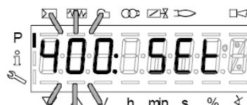
Нажать во второй раз: на дисплее появится процент нагрузки, на которой горелка работает.
