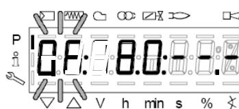
Если необходимо ввести угол открытия воздушной заслонки “0A” в точке розжига (например  $10^\circ$  - см. ниже) нажать “A” и одновременно “+” или “-”:
