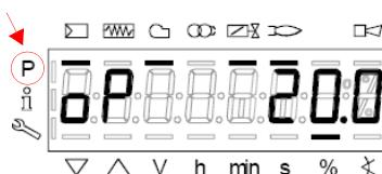
Тире рядом с символом “Р” (выделенный на рисунке) исчезнет, указывая на то, что менеджер вышел из модальности программирования. Таким образом, горелка будет работать автоматически, согласно запрограммированной рабочей кривой.
