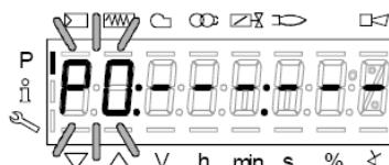
Нажать “F” и “+” для увеличения угла открытия сервопривода топлива “OF” до желаемого значения (например  $12^\circ \div 15^\circ$  - см. ниже) для точки розжига или “F” и “-” - для уменьшения угла
