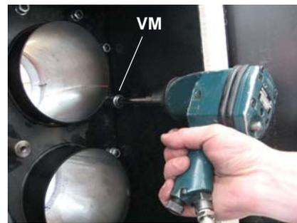
17 per sostituire i boccagli dall'esterno, procedere nel modo seguente: svitare i grani di fissaggio **VB** ed estrarre il boccaglio danneggiato per sostituirlo. Per sostituire i boccagli dall'interno procedere nel modo seguente: svitare le viti **VM** ed estrarre la piastra boccagli; procedere alla sostituzione del/dei boccagli danneggiati.
