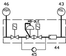
A seconda del tipo di bruciatore e della dimensione della rampa gas, le valvole MB-DLE sono fornite al posto delle VGD. In questo caso, l'elemento 42 è incluso nel gruppo valvole. Vedi lo schema qui a lato.
