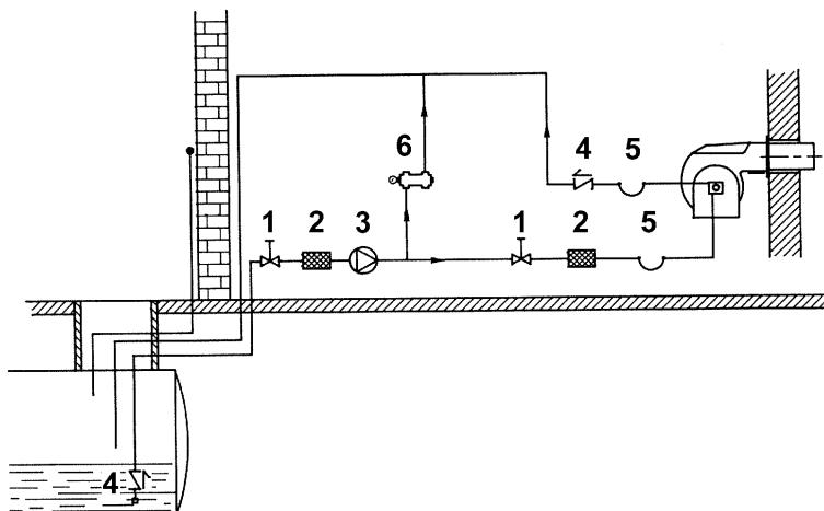
Рис. 14- - Контур подачи топлива всасыванием
