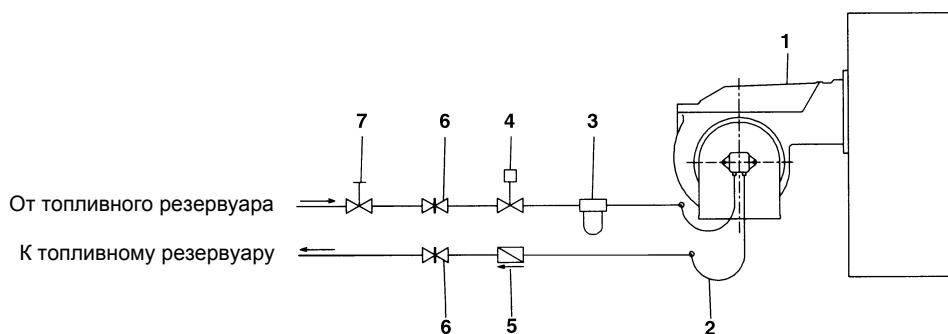
Рис. 15 - Двухтрубная система
