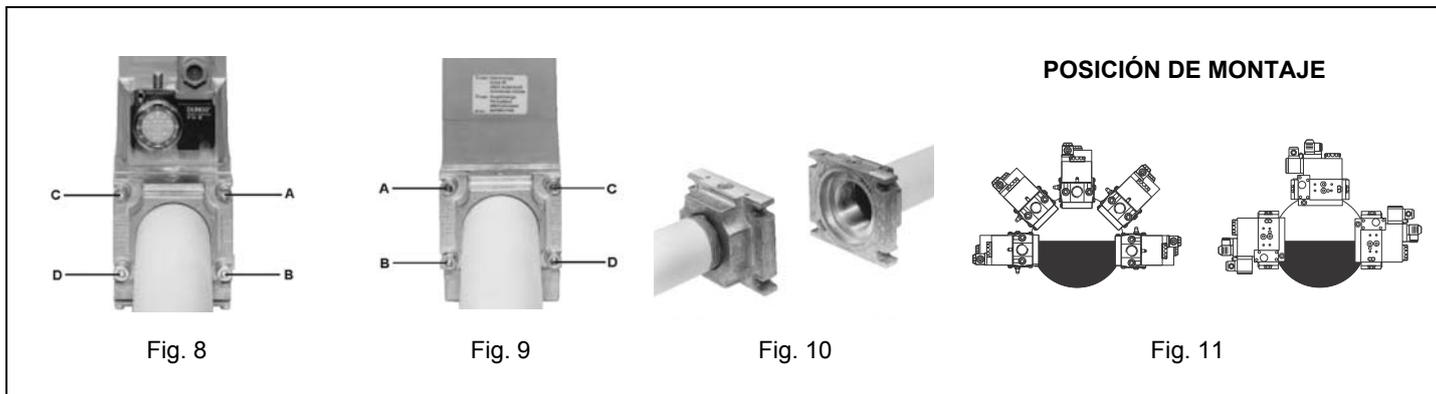
**Válvulas gas Siemens VGD - Versión con SKP2. (con estabilizador de presión incorporado)**
