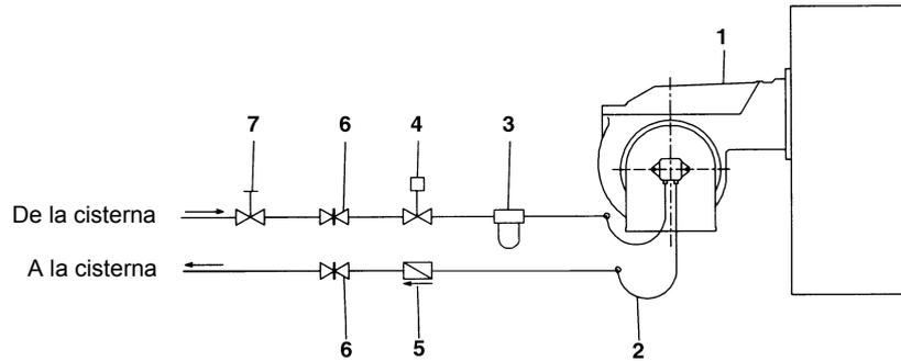
Fig. 16 - Sistema bitubo
