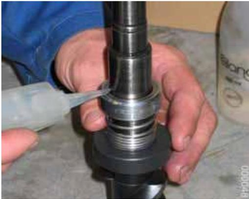
4. Тщательно очистить промывочным бензином поверхности скольжения скользящего кольца **457,3\*** и ответного кольца **457,2\***, а затем их смазать одной каплей смазочного масла, не содержащего смолы. После этого более не дотрагиваться до поверхностей скольжения.
