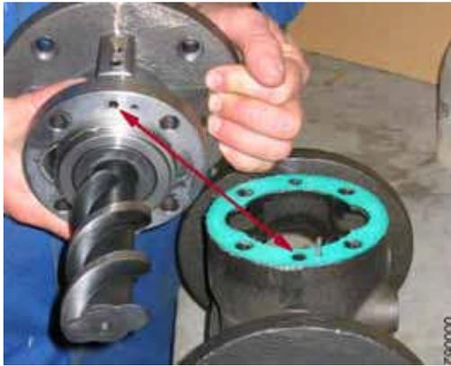
8. Провернуть предварительно собранный узел настолько, чтобы разгрузочное отверстие во фланцевой крышке **074** оказалось в таком же положении, как соответствующее отверстие в корпусе насоса **131**. При этом соблюдать положение цилиндрического штифта **879**.
