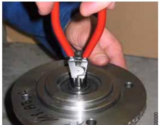
4. Снять кольцо фиксации вала **471,2** и опорную шайбу **056**.
