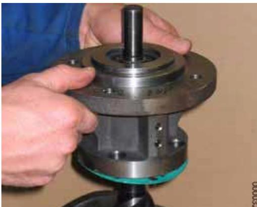
2. Вынуть выдвигной блок, состоящий из главного винта, подшипниковой опоры, уплотнения и фланцевой крышки, из корпуса насоса **131**.
