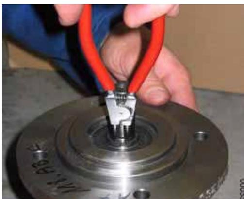
10. Надвинуть опорную шайбу **056** и смонтировать кольцо **471,2** для фиксации главного винта.
