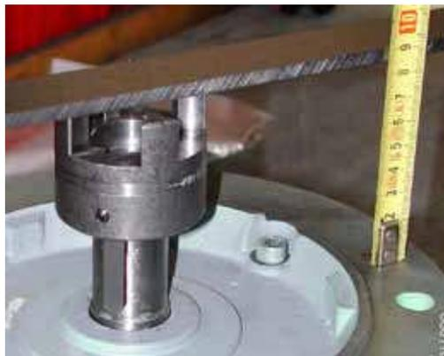
6. Проверить расстояние между торцевой поверхностью зубьев муфты и соединительной поверхностью фланца двигателя. Это расстояние необходимо отрегулировать на значение  $x - c$  (см. Таб. 2, стр. 24).
