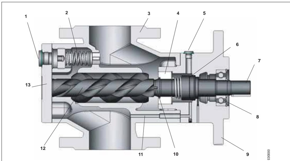
Рис. 1 Конструкция винтового насоса
