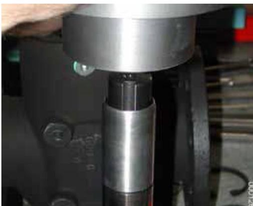
8. Перед монтажом главного винта надвинуть подходящую защитную гильзу, которая защитит уплотнительное кольцо от повреждения шпоночным пазом и буртиком вала. Ввести главный винт во фланцевую крышку с предварительно
