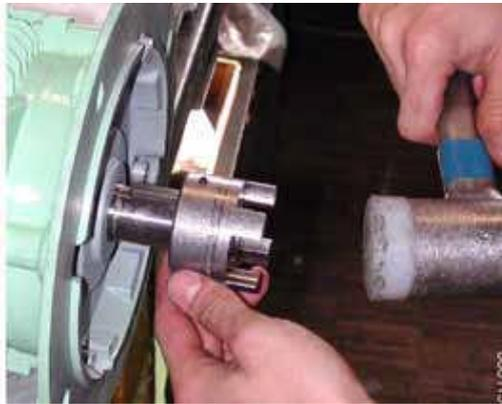
5. Насадить полумуфту со стороны двигателя **052,2** легкими ударами мягкого молотка по концу вала двигателя. Монтаж можно облегчить, нагрев муфту до 80...100°C.
