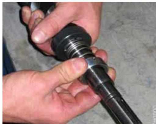
3. Тщательно очистить главный винт **661,1** в зоне торцового уплотнения и смазать его консистентной смазкой. Насадить опорную шайбу **062,1**. Осторожно вращая коническую пружину сжатия **457,6\***, нажимное кольцо **457,5\*** и скользящее кольцо **457,3\*** с уплотнительным кольцом **457,1\*** запчасти, надвинуть их на главный винт. Убедиться в том, что при преодолении буртиков вала уплотнительное кольцо не повреждается.
