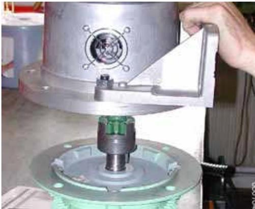
2. Отпустить соединительные винты **900** между электродвигателем **529** и держателем насоса **180** и снять с электродвигателя насос **001** с держателем насоса.
