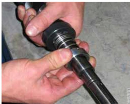
6. С легким вращением сдвинуть вниз скользящее кольцо **457,3\*** с конической пружиной сжатия **457,6\***, нажимное кольцо **457,5\*** и уплотнительное кольцо **457,1\*** с главного винта **661,1**. Снять с вала опорную шайбу **062,1**.
