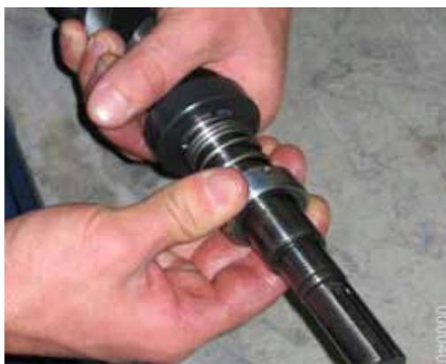
7. Тщательно очистить главный винт в зоне торцового уплотнения и смазать его консистентной смазкой. Насадить опорную шайбу **062,1**. Осторожно вращая коническую пружину сжатия **457,6\***, нажимное кольцо **457,5\*** и скользящее кольцо **457,3\*** с уплотнительным кольцом **457,4\*** запчасти, надвинуть их на главный винт. Убедиться в том, что при преодолении буртиков вала уплотнительное кольцо не повреждается.
