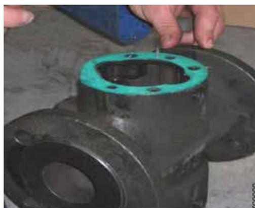
7. Снять с новой прокладки **729,5** пленку для защиты клеевого слоя. Наложить прокладку на корпус насоса **131** и слегка прижать.
