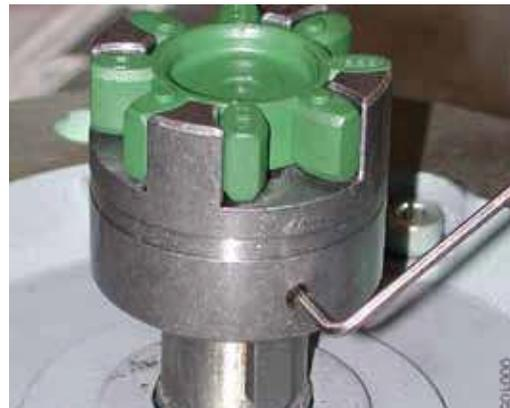
7. Вставить упругое промежуточное кольцо муфты **525** и затянуть фиксирующий винт на полумуфте **052,2**.
