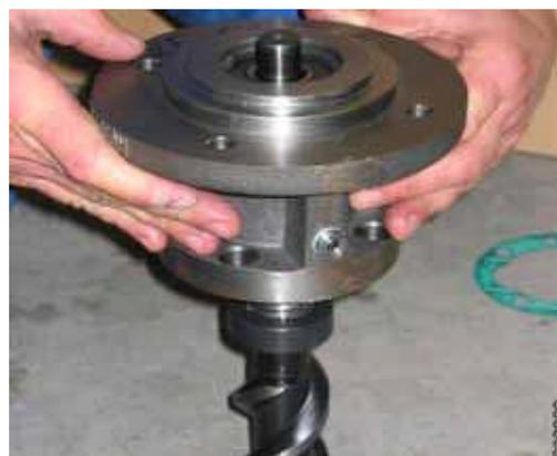
5. До упора запрессовать главный винт **661,1** с надвинутыми деталями запасного уплотнения в шарикоподшипник **817** во фланцевой крышке **074**.
