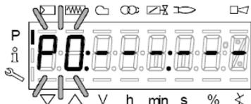
Нажать “F” и “+” для увеличения угла открытия сервопривода топлива “OF” до желаемого значения (например 12°±15° - см. ниже) для точки розжига или “F” и “-” - для уменьшения угла
