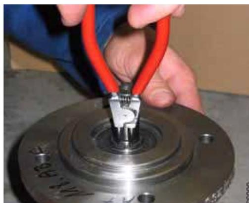
6. Надвинуть опорную шайбу **056** и смонтировать кольцо **471,2** для фиксации главного винта **661,1**.
