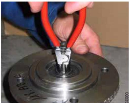
6. Надвинуть опорную шайбу **056** и смонтировать кольцо **471,2** для фиксации главного винта.
