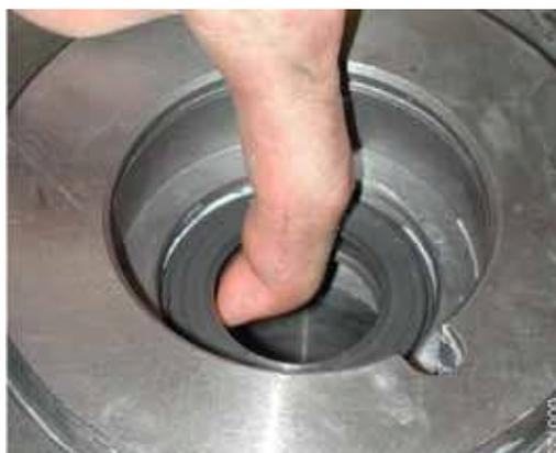
6. Снять опорную шайбу **745,2\*\*** и радиальное уплотнительное кольцо **745,3\*\***. Если вручную это сделать не удастся, воспользоваться подходящей оправкой. Как правило, при демонтаже уплотнительное кольцо разрушается.
