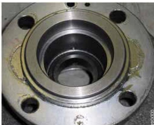
4. Вставить во фланцевую крышку ответное кольцо **457,2\*** запчасти с насаженным уплотнительным кольцом **457,1\***. При этом обращать внимание на то, чтобы разжимной штифт **859** вошел в засечку ответного кольца для фиксации против проворачивания.
