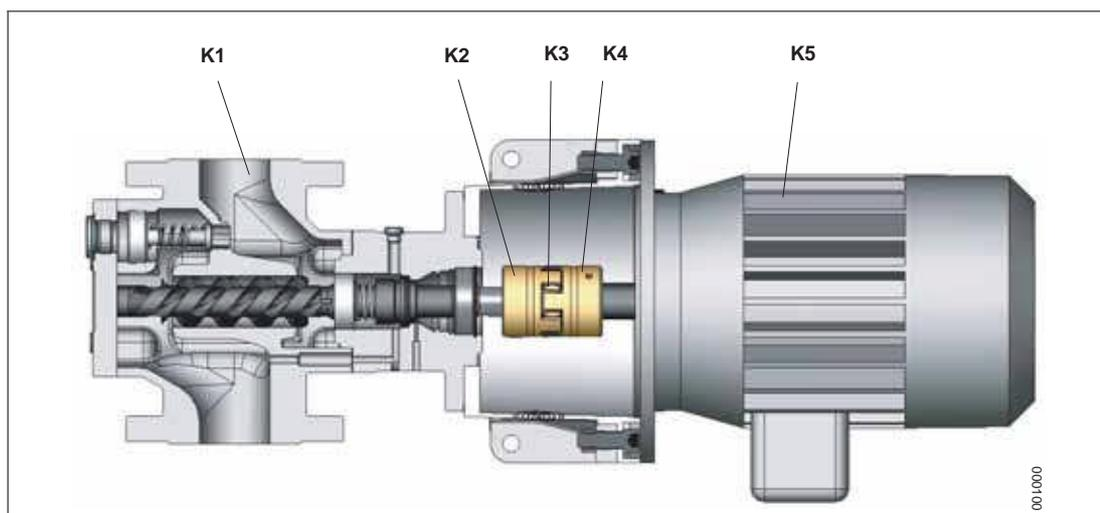
Рис. 2 Конструкция винтового насоса с муфтой и электродвигателем
