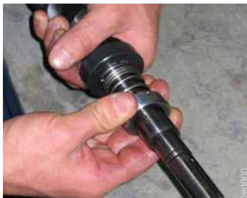
8. С легким вращением сдвинуть вниз скользящее кольцо **457,3\*** с конической пружиной сжатия **457,6\***, нажимное кольцо **457,5\*** и уплотнительное кольцо **457,4\*** с главного винта. Снять с вала опорную шайбу **062,1**.
