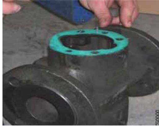
7. Снять с новой прокладки **729,5** пленку для защиты клеевого слоя. Наложить прокладку на корпус насоса **131** и слегка прижать.
