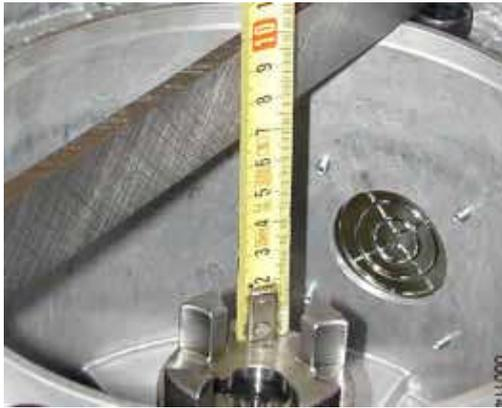
4. Измерить расстояние  $X$  между торцевой поверхностью муфты и соединительной поверхностью держателя насоса.
