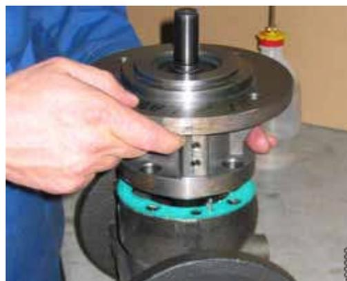
14. Задвинуть предварительно собранный узел из фланцевой крышки и главного винта в корпус насоса, так чтобы главный винт вошел в зацепление с ведомыми винтами **661,2**. При этом вращать главный винт. Ввернуть и затянуть винты с цилиндрической головкой **914,1** на фланцевой крышке.
