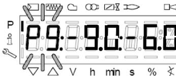
**ВНИМАНИЕ:** при первой настройке горелки, рекомендуется устанавливать точку максимальной нагрузки P9 на значения точки розжига (или на значение, которое немного превышает значение точки розжига), с тем, чтобы впоследствии достигать точку P9 в безопасном режиме (см. следующий параграф).
