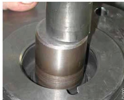
5. С помощью оправки осторожно запрессовать радиальное уплотнительное кольцо **745,3\*\***. При чрезмерном сопротивлении нанести в качестве смазочного материала дополнительный герметик для резьбы.
