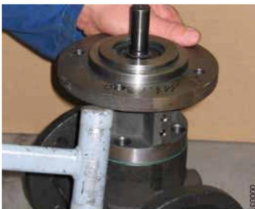
1. Вывернуть четыре винта с цилиндрической головкой **914,1** на фланцевой крышке **074** и отсоединить фланцевую крышку легкими ударами с отскоком.
