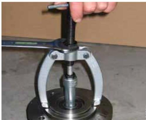
5. Снять кольцо фиксации вала **471,3** и вынуть шарикоподшипник **817** из фланцевой крышки с помощью подходящего съемника.
