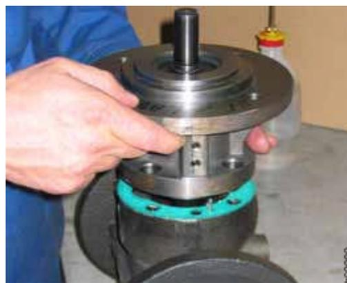
13. Задвинуть предварительно собранный узел из фланцевой крышки **074** и главного винта **661,1** в корпус насоса **131**, так чтобы главный винт вошел в зацепление с ведомыми винтами **661,2**. При этом вращать главный винт. Ввернуть и затянуть винты с цилиндрической головкой **914,1** на фланцевой крышке.
