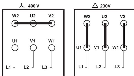
Collegamento delle resistenze di riscaldamento olio combustibile
