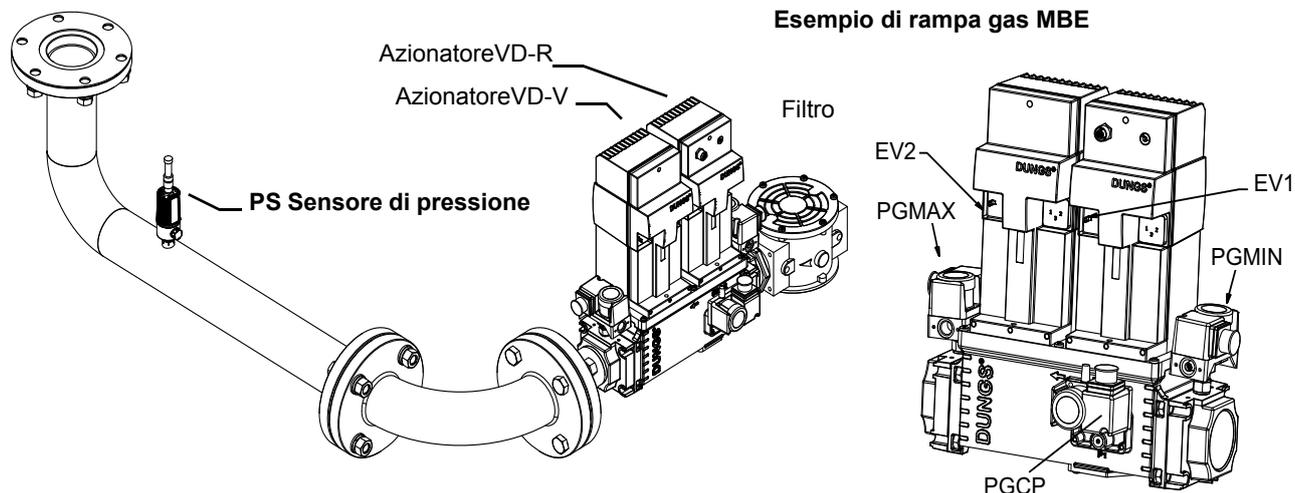
Per montare la rampa del gas, procedere nel seguente modo:
