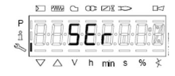
Il livello Service permetti di visualizzare informazioni sull’intensità di fiamma, posizione servocomandi, numero e codici di blocco:
