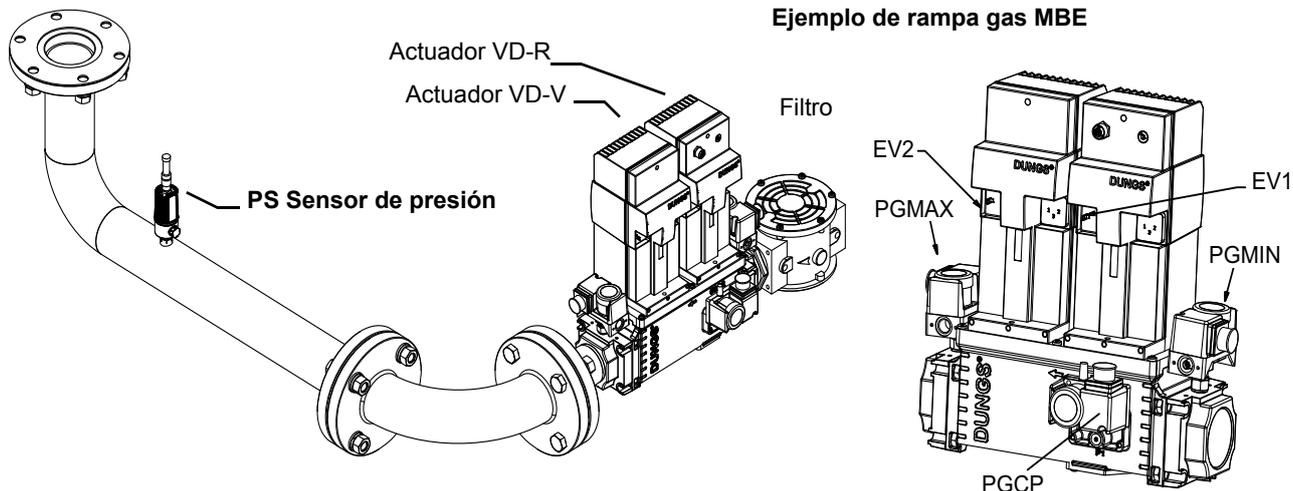
Para montar la rampa del gas, proceder en el siguiente modo:
