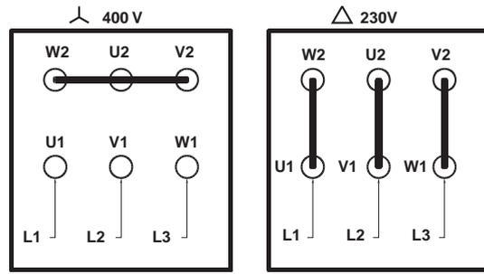
Conexión de las resistencias de calentamiento fuel pesado
