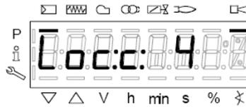
significa que el quemador está **bloqueado (Lockout)** con código de error (Error code): en el ejemplo "Código de error: 4". También se visualizará de forma alternada el mensaje
