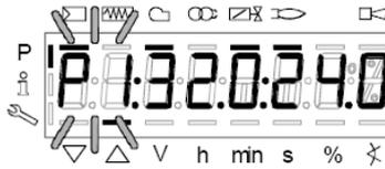
Configurar la curva de relación aire/combustible como se describe en la sección "configuración en caliente" en el capítulo anterior "Programación de la LMV2x".
