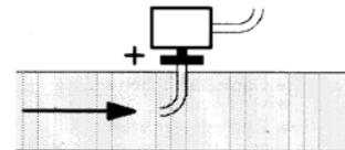
**Conexión sonda de presión Siemens QBE2...P...**
