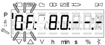
Если необходимо ввести угол открытия воздушной заслонки “0A” в точке розжига (например 10° - см. ниже) нажать “A” и одновременно “+” или “-”.)
