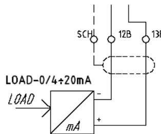
В случае принятия решения поменять Уставку - Set Point снаружи или контролировать нагрузку снаружи с помощью сигнала на клеммах X62, выбрать тип сигнала следующим образом:
