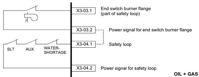
SLT: предохранительный термостат (safety loop thermostat)
