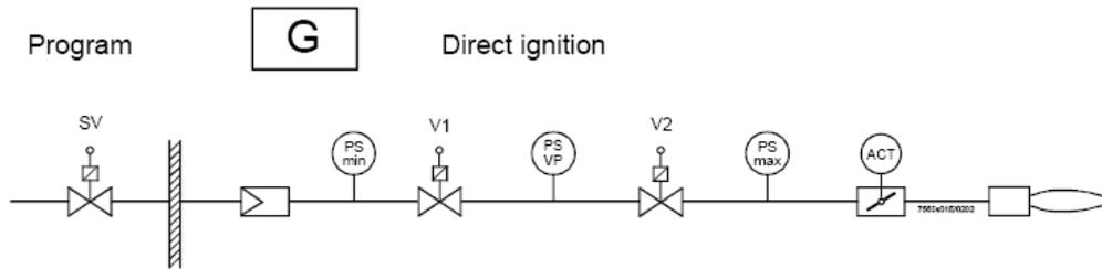
**SV** = Предохранительный клапан
