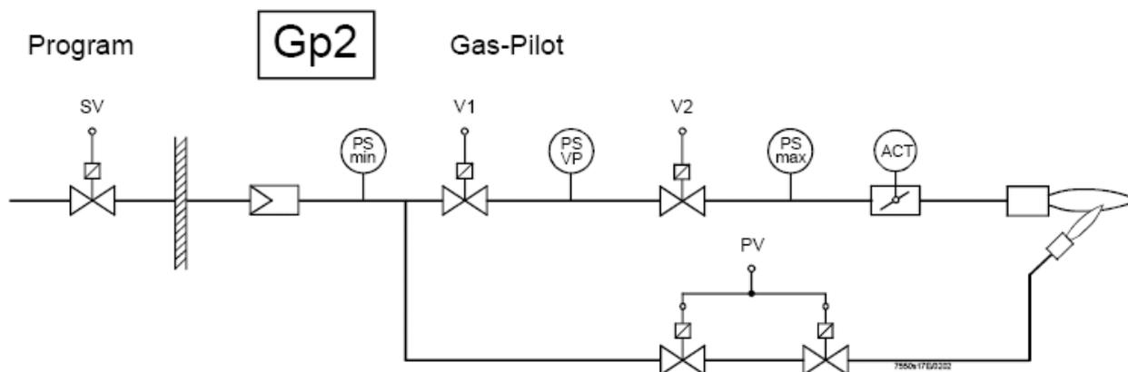
**SV** = Предохранительный клапан
