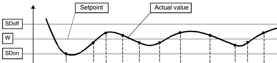
Для введения этих значений, выбрать с помощью стрелок обозначение ДиапПер\_мод\_ВКЛ (SDon), опускаясь вниз меню “РегулМощности”, нажать ENTER.
