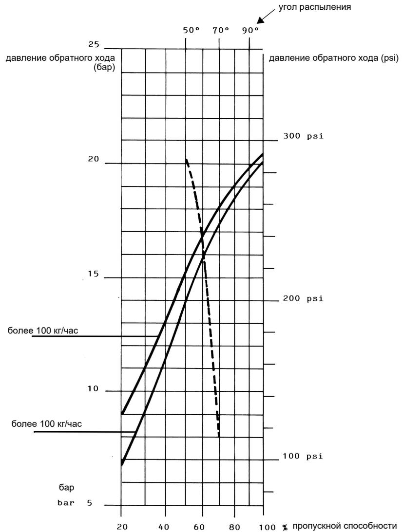
**ДАВЛЕНИЕ ТОПЛИВА НА ФОРСУНКЕ = 25 бар**
